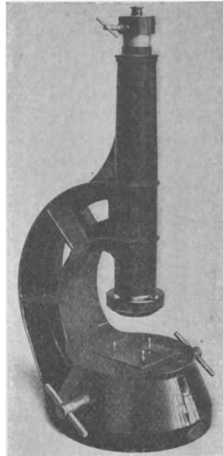
Abb. 50. Autokollimationsfernrohr zum Prüfen der Parallelität der Meßflächen.
