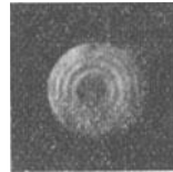
Abb. 80. Interferenzstreifen an einer schlechten Meßfläche eines zylindrischen Endmaßes.
