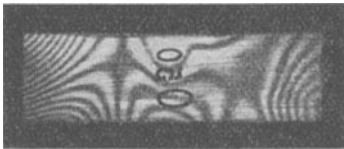
Abb. 78 a und b. Interferenzstreifen an einem durch innere Spannungen verzogenen Endmaß mit sonst parallelen Meßflächen.
