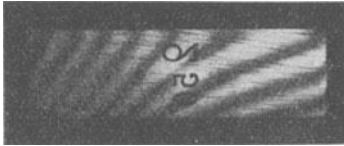
Abb. 76. Interferenzstreifen an einer schwach gewölbten Fläche.
