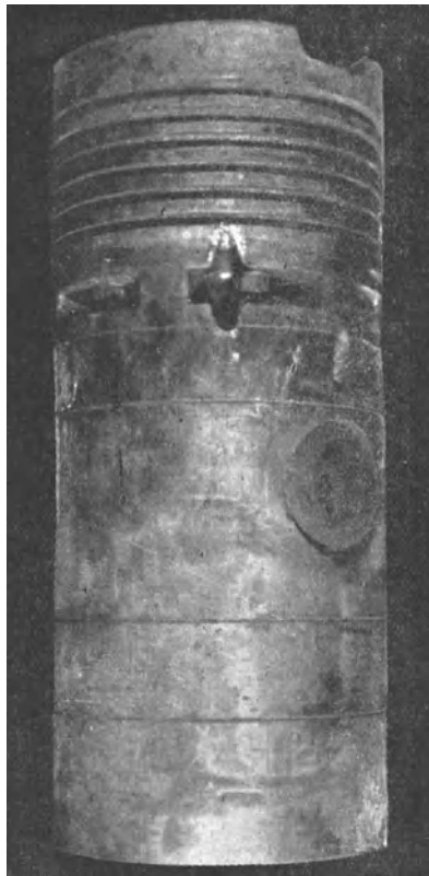
Die Folgen der gelosten Schraubennutter an einem zweiteiligen Kolben.
