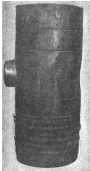
Ein eingefressener Kolben.
