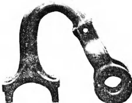
Eine beim Anlassen gebogene Pleuelstange einer Kreuzkopfmaschine.
