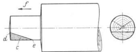
Abb. 68. Kernführung mit abgeschrägter Kernmarke.
