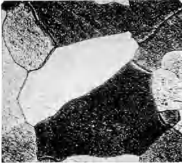
Abb. 1. Reines Eisen, Kornfärbungsätzung. 200\times ( \alpha -Eisen). [Nach OBERHOFFER (19).]
