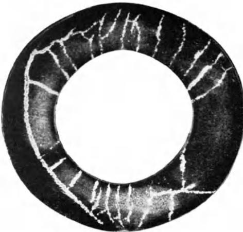
Abb. 47. Durch Salmiaklösung kenntlich gemachte Schleifrisse auf der Oberfläche einer gehärteten Unterlagsscheibe.
