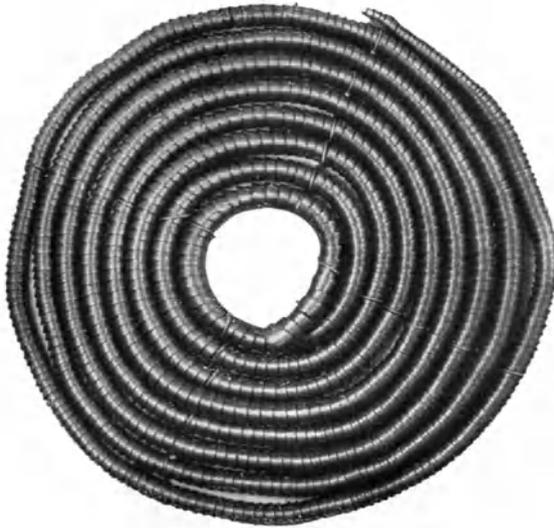
Abb. 68. Drehspan von „freischneidendem Stahl“.
