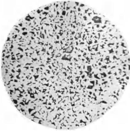
Abb. 87. Ausgeglühter einfacher Kohlenstoffstahl.
