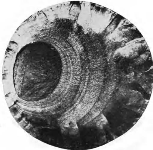
Abb. 120. Dauerbruch bei einer Eisenbahnwagenachse.
