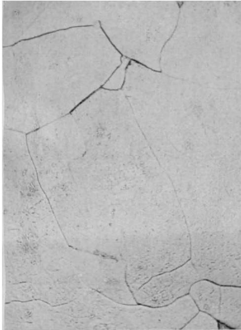
Abb. 3. Helle Stellen der Abb. 1. Ferrit.  $\times 750$ .
