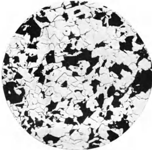
Abb. 18. Bolzen nach der Abkühlung unter  $670^{\circ}\text{C}$ .  $\times 100$ .
