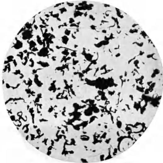
Abb. 44. Auf einer Glasplatte aufgefangene Schleiffunken.  $\times 20$ .
