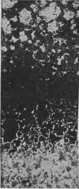
Abb. 107. Kleingefüge der schnell erkalteten Schnittfläche eines mit Sauerstoffschneider zerschnittenen Stahlblechs.
