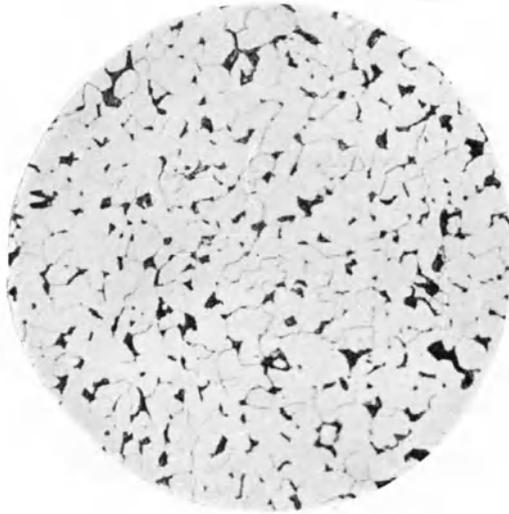
Abb. 64. Gut bearbeitbarer Stahl.  $\times 100$ .
