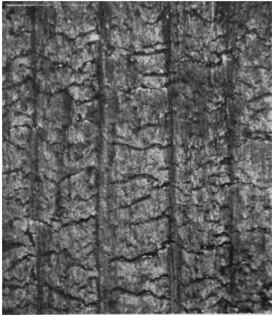
Abb. 66. Durch grobe Bearbeitung erhaltene rissige Oberfläche eines Stahlgegenstandes. Vergrößert.
