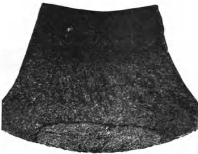
Abb. 99. Durch Druck hervorgerufene Risse bei einem Biegeprobestab. —
