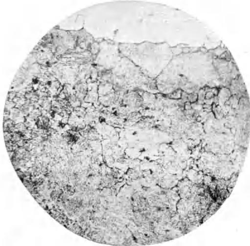
Abb. 51. Abgeschreckter Stahl mit kohlenstofffreier Außenschicht.  $\times 100$ .
