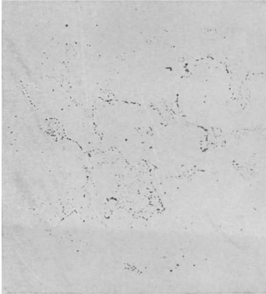
Abb. 54. Zementithüllen in einem langsam abgekühlten weichen Stahl.  $\times 100$ .
