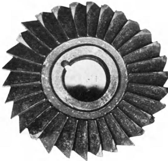
Abb. 97. Durch Härtung hervorgerufene Absplitterung der Zähne eines Fräasers.
