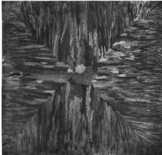
Abb. 94. Polierter und geätzter Querschnitt eines Chromstahlblocks.
