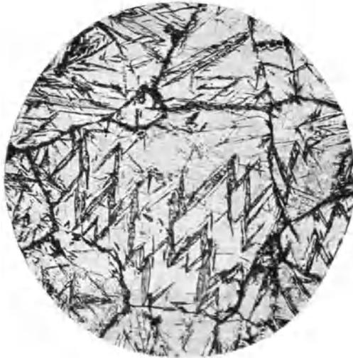
Abb. 72. Austenitisches Gefüge (helle Grundmasse) mit Martensitresten.
