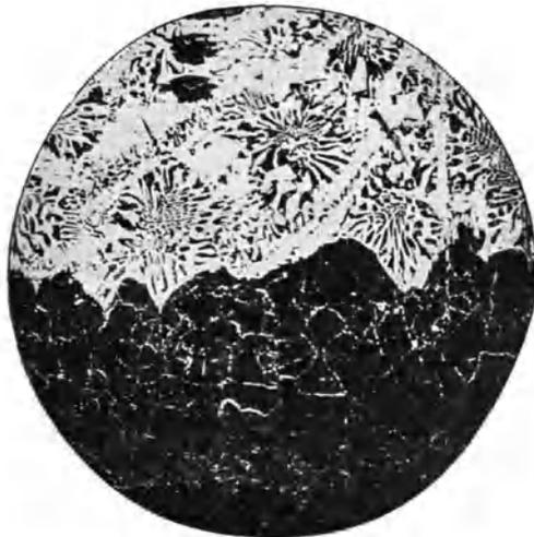
Abb. 80. Aus Abb. 79. Gefüge eines zementierten Zahnes eines Zahnrades nach der Aufnahme von Phosphor aus dem Kohlungsmittel.  $\times 100$ .
