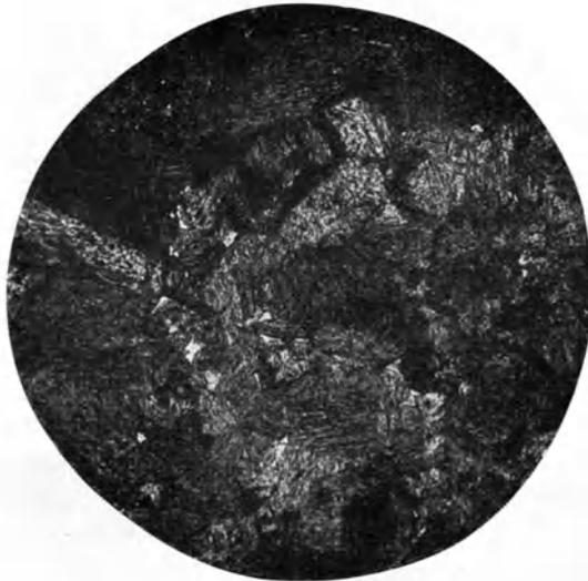
Abb. 14. Bolzen bei der Abkühlung von  $800^{\circ}\text{C}$  abgeschreckt.  $\times 100$ .
