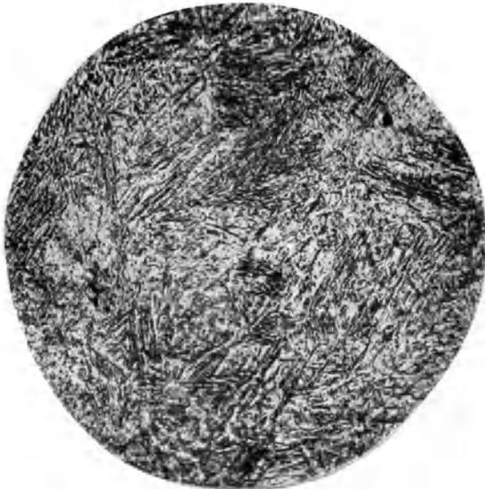
Abb. 71. Martensitisches Gefüge. In spitzen Winkeln zu einander verlaufende Nadeln.  $\times 800$ .
