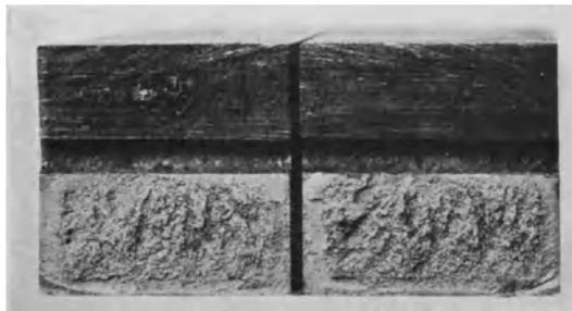
Abb. 118. Bruchgefüge eines einsatzgehärteten Flußeisenstabes nach dem Kerbschlagversuch (Rundkerb).  $\times 1$ .
