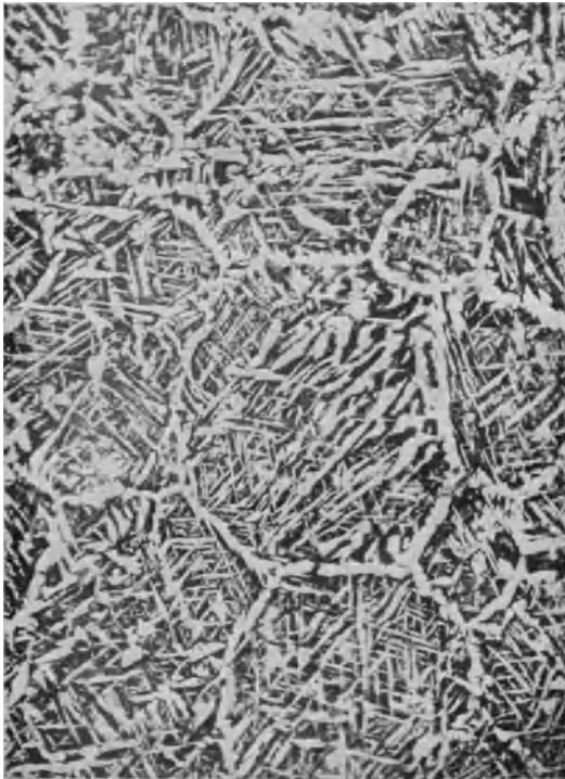
Abb. 5. Gefüge eines überhitzten weichen Stahls.  $\times 25$ .
