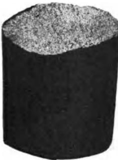
Abb. 111. Kurzbrüchiger spröder Stahl.
