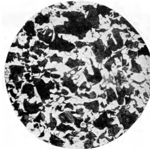
Abb. 16. Bolzen bei der Abkühlung von  $740^{\circ}\text{C}$  abgeschreckt.  $\times 100$ .
