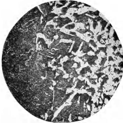
Abb. 63. Übergangsgefüge zwischen der reinen perlitischen Zone (links) und der perlitisch-ferritischen Zone (rechts).  $\times 200$ .
