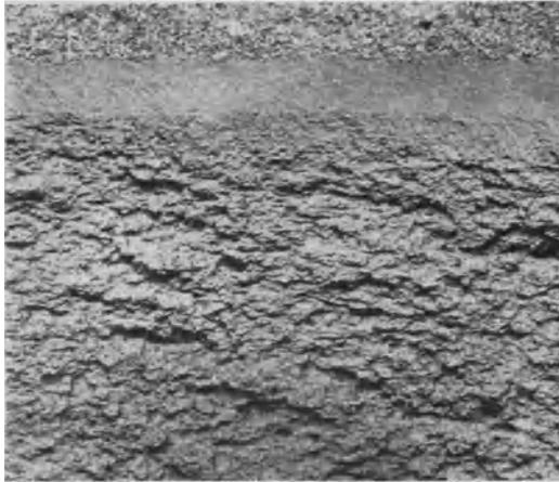
Abb. 31. Grobes kristallinisches Bruchgefüge durch freien Zementit verursacht.
