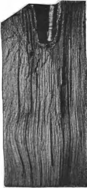
Abb. 37. Sehniger Bruch längs der Achse einer einsatzgehärteten Matrize.  $\times 1\frac{1}{2}$ .
