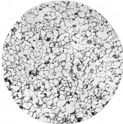
Abb. 62. Flußeisen mit 0,05 vH Kohlenstoff. Feiner Ferrit, wenig Perlit.  $\times 200$ .
