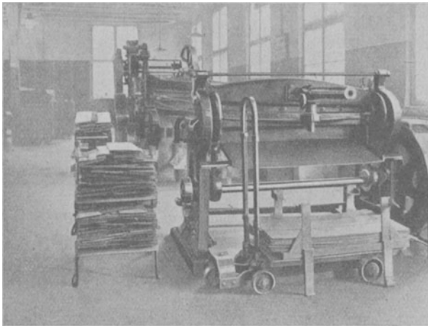
Abb. 119. Das genormte Stapelgestell in Arbeitsstellung an einer Kurbelschere.
