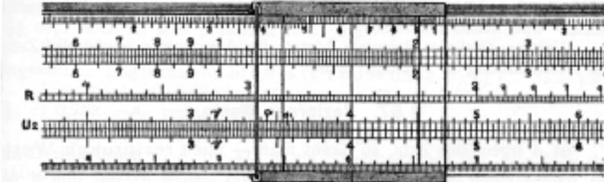
Es ist noch zu bemerken, daß bei der Berechnung einer Reihe von Reziprokwerten die Zunge verschoben werden muß, wenn man das erste Verfahren wählt, beim zweiten und dritten ist nur eine Läuferverschiebung notwendig.
