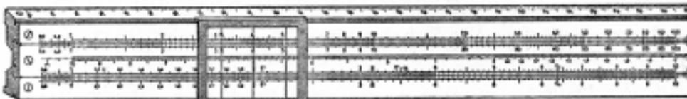
An der schrägen und senkrechten Kante ist eine einfache Millimeterteilung angebracht, die zu den Längenmessungen sehr erwünscht ist. Reicht sie nicht aus, so setzt man das linke Ende des Stabes an den Anfang der zu messenden Linie und zieht die Zunge so weit nach rechts heraus, bis ihr Ende mit dem Endpunkt der Linie zusammenfällt. Dann trifft das linke Ende der Zunge einen Teilstrich der in der Mitte des
