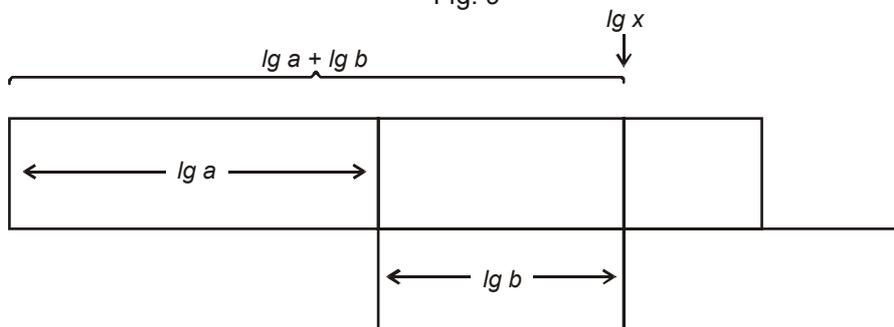
**Satz I.** Um das Produkt  $a \cdot b$  zu bilden, schiebt man den Anfangsstrich "1" einer Zungenteilung unter die Ziffer  $a$  der zugehörigen Skala des Lineals. Dann bewegt man den Glasläufer so weit, bis der schwarze Strich über der Ziffer  $b$  der benutzten Zungenskala steht. Unter ihm findet man auf der festen Skala sofort das Ergebnis  $a \cdot b$ .
