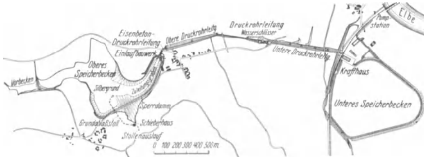
Abb. 139. Pumpspeicherwerk Niederwartha, Lageplan. (Wasserkr. u. Wasserwirtsch. 1930.)
