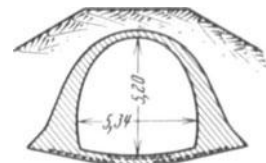
Abb. 251. Eingedeckter Freispiegelkanal der Catskillwasserleitung von New York. (Wkr. 1913.)
