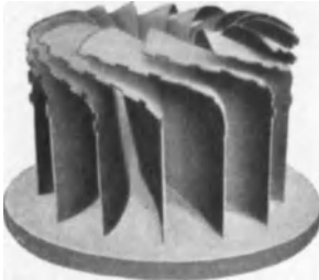
Abb. 431. Stahlblechschaufeln eines Francislaufrades.
