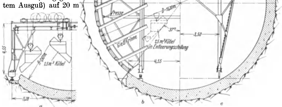
Abb. 287. Auskleidung der Umlaufstollen der Hooverdamm. (Engng. News Rec. 1932.) a Sohlenbetonierung. b Einbringung des Seitenbetons. c Verfahrenbare Gewölbeschalung. (Im Gewölbe Preßluftbetonierung!)
