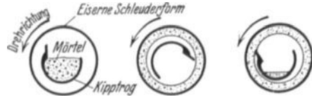
Abb. 331. Schleudervorgang beim Verfahren Moir und Buchanan, Wirkungsweise des Kipptruges und Abstreifmessers. (Bautechn. 1930.)
