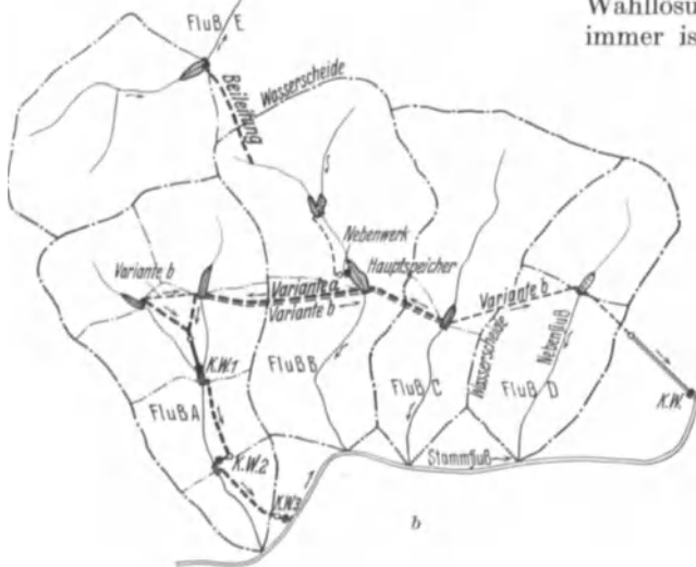
Abb. 114a u. b. a Seitliches Sammelgebiet mit Einzelausbauten. b Ausbau eines seitlichen Sammelgebietes mit starker Quersammenfassung.
