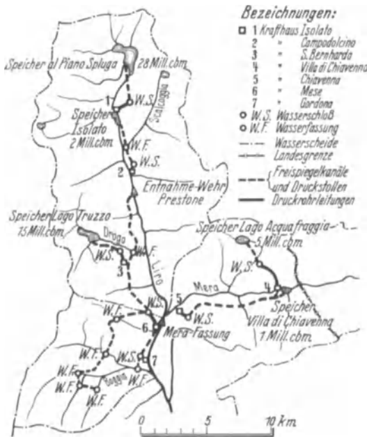
Abb. 118. Beispiel umfassenden Ausbaues eines größeren Gebietes (Liro- und Mera-Ausbau). Lageplan. (En. Elett.)
