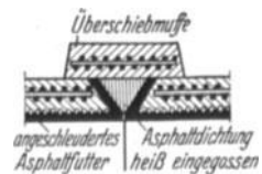
Abb. 333. Stößerverbindung eines Billé-Lignonnet-Eisenbetonrohres mit Überschiebmuffe. (Bautechn. 1930.)
