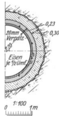
Abb. 261. Schwer armiertes Profil für druckhaftes Gebirge. (Nach Locher.)
