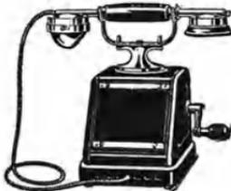
Abb. 1224 a. Tischapparat mit Induktor (OB)
