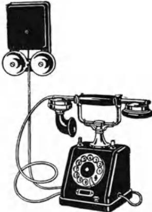
Abb. 1236. Tischapparat mit Rückfrageeinrichtung.
