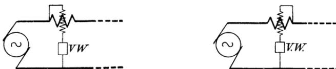
Abb. 87a und 87b. Schaltung von Leistungsmessern.
