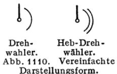
einen — in der Regel zehnteiligen<sup>1)</sup> — Drehwähler (Vorwähler, VW) zu, dessen Schaltarm beim Abnehmen des Hörers schnell gedreht wird und auf einem Drehschritt stehen bleibt, der zu einem freien Heb-Drehwähler führt (Abb. 1108). Die Drehschritte der VW einer 100-Gruppe sind vielfach geschaltet
