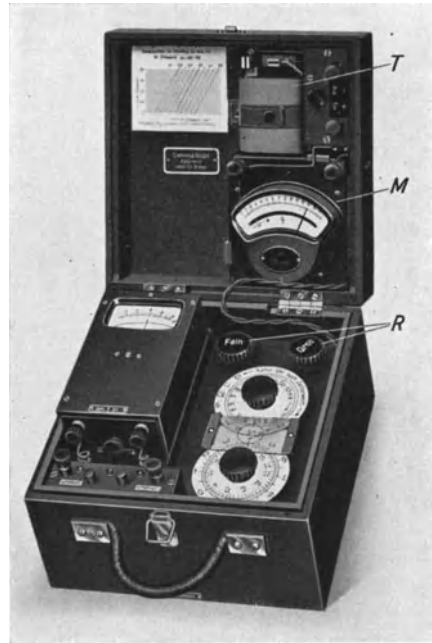
T = Taschenlampenbatterie, M = Strommesser, R = Meßstromregler
