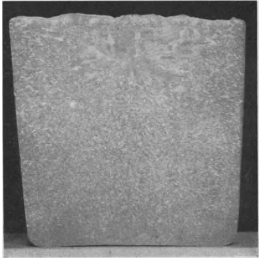
Abb. 5. Kupferbarren mit feinkörnigem Gefüge.
