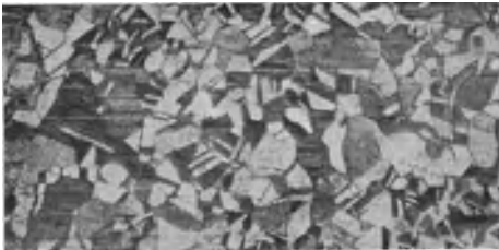
Abb. 30. Feinkörniges \alpha -Messing mit glatter Tiefungsprobe.
