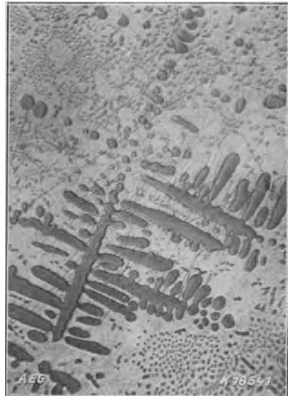
Abb. 16. Kupferoxydul (übereutektisch) (AEG).
