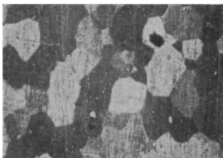
Abb. 23. Reines \beta -Gefüge im Ms 58 (abgeschreckt).
