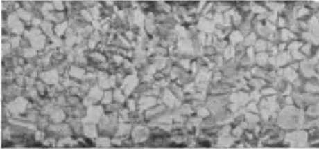
Abb. 32. \alpha -Gefüge mit dunklen \beta -Einschlüssen.
