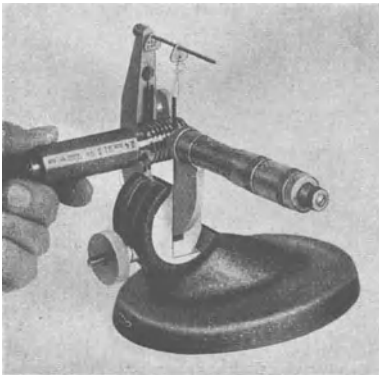
Abb. 29. Messen des Flankendurchmessers mit 3 Drähten. (Carl Zeiss, Jena.)
