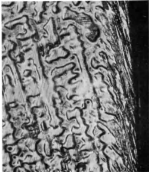
Abb. 198. Lagerbronze mit dendritischem Gefüge, deren Oberfläche durch Aufdornen verschmiert wurde.
