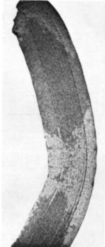
Abb. 190. Rekristallisierte Stelle an einer Ventilatorstrebe. Deutliche Ausbildung des Zug- und Druckkegels.
