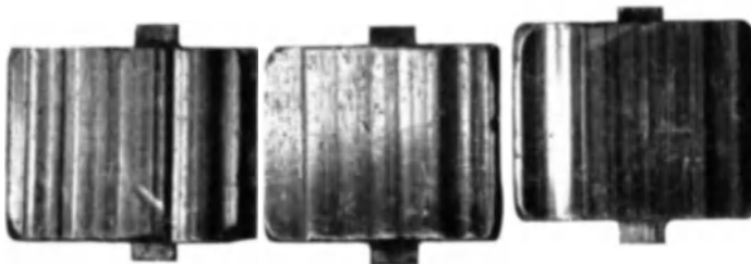
Abb. 49. Bürsten mit starker Rillenbildung.
