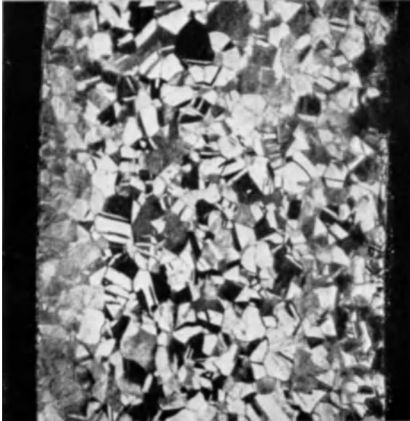
Abb. 202. Gefügebild aus einem Kühlerrohr. Legierung: 70% Kupfer, 29% Zink und 1% Zinn (reines \alpha -Gefüge).
