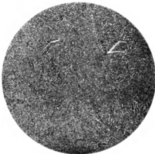
Abb. 201a. Eutektisches Gefüge eines Silberlotes. Gleichmäßige feine Körnung.
