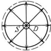
Abb. 54. Kräfte an einer drehenden Scheibe mit dem Massen-schwerpunkt S in der Drehachse D .
