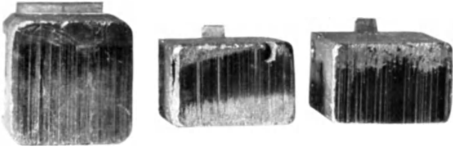
Abb. 44. Zonenbildung in der Lauffläche von Hochgraphitkohlen infolge unrichtiger Einstellung des Wendefeldes.
