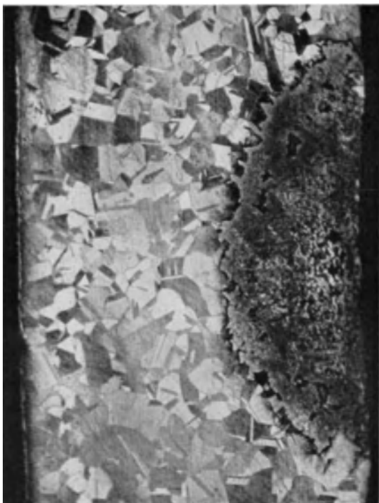
Abb. 203. Selektiv korrodiertes Kühlerrohr (reines \alpha -Gefüge), Kupferpfropfen auf der rechten Seite der Abbildung.
