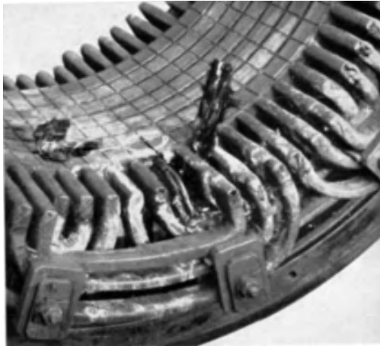
Abb. 19. Windungsschluß im Ständer eines 700-kW-Drehstrommotors.
