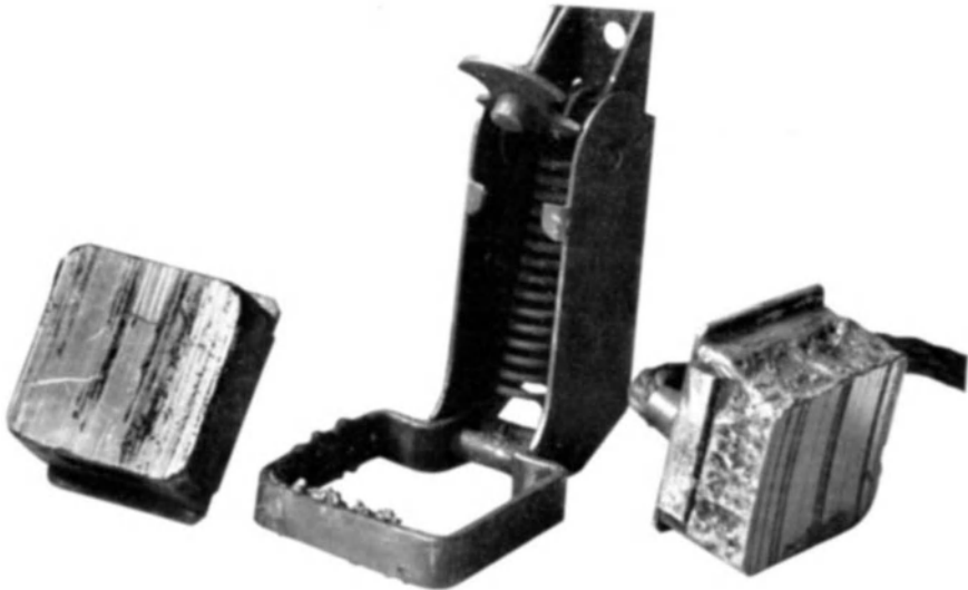
Abb. 32. Rechts: Beschädigte Bürste und Halter als Folge ungleicher Stromverteilung. Links: Metalleinschlüsse in der Bürstenlauffläche.
