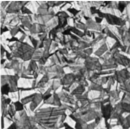
Abb. 197. Gefüge einer Lagerbronze, bestehend aus polygonalen Mischkristallen.
