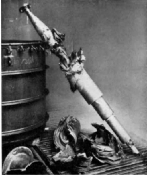
Abb. 125. Durchschlag einer Kondensatorklemme mit explosionsartiger Wirkung.
