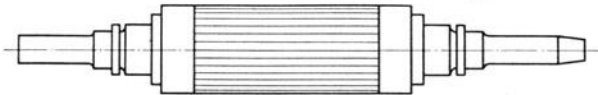
Abb. 60. Zweipoliger Läufer eines Turbogenerators: Typus des Läufers, bei dem sich dynamische Wuchtfehler besonders geltend machen.
