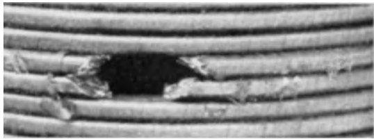
Abb. 122. Windungsschluß an einer einlagigen Spule.
