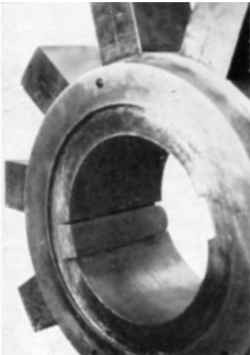
Abb. 25. Keil und ausgeschlagene Keilbahn als Folge von Kurzschlüssen.
