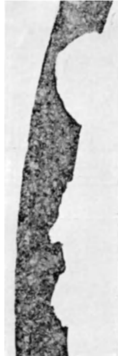
Abb. 204. Anfrassungen an einem Kühlerrohr. Auf der rechten Seite sind infolge des Ausbruches des Kupferpfropfens zum Teil fast durchgehende Anfrassungen vorhanden.
