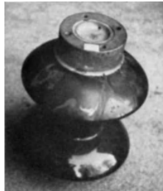
Abb. 218. Lichtbogenanbrennungen an einem Porzellanisolator.
