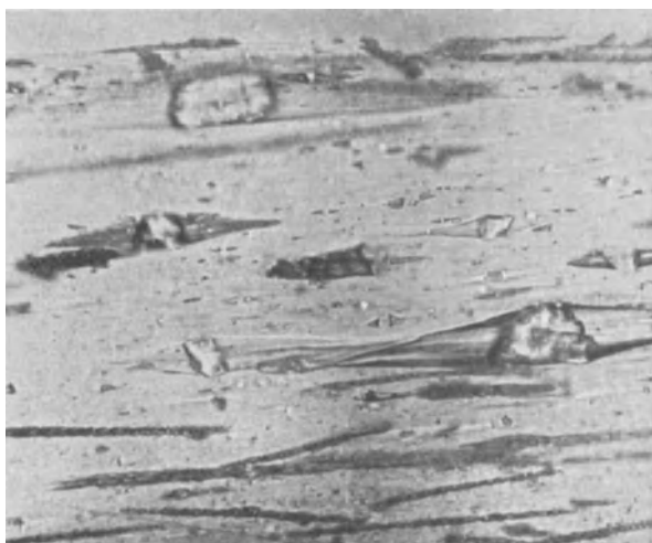
Abb. 25. Kautschukmischung, die Schwerspat enthält, unter Spannung. 380 \times .
