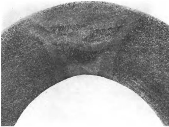
Abb. 143. V-Schweißung mit mehreren deutlich sichtbaren Raupen übereinander, hergestellt mit der Reisenauer Hochleistungselektrode. Biegeprobe 180° bei 3fachem Dorndurchmesser (Material ungeglüht). Auffallend ist die außergewöhnliche Verformbarkeit der Schweißzone.
