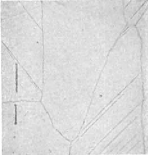
Abb. 90. Gleitlinien infolge Überbeanspruchungen bestimmter Materialzonen.
