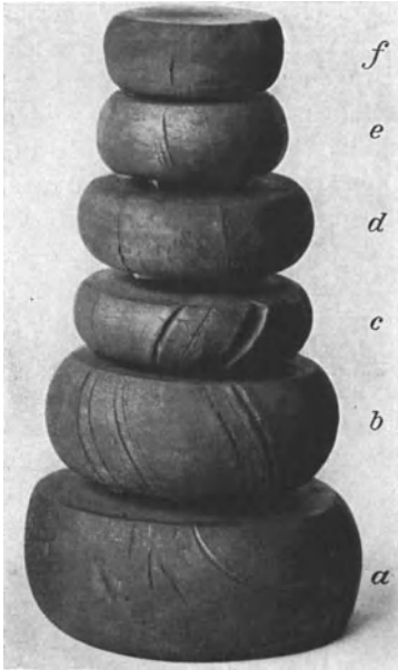
Abb. 113. Warmstauchversuche an Stahl 38 · 13 verschiedenen Durchmessers. Dabei zeigt a geringe ausgerundete Furchen, die nur nachweislich von Oberflächenriefen herrühren, b flache ausgerundete und scharfe tiefe Risse, letztere müssen, da ebenso wie bei c die Schwefelseigerungen austreten, auf Rotbruch zurückgeführt werden, d , e , f zeigen außerordentlich scharfe, aber geringe Anrisse, die auf kleine Schlackenstellen, die zufällig an der Außenhaut liegen, zurückzuführen sind.
