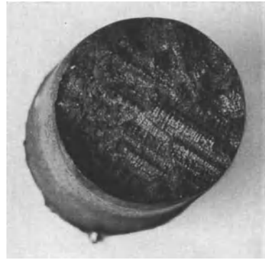
Abb. 270. Bruch eines Zugprobestabes, der Dendriten (Tannenbaumkristalle) eines ungenügend durchgeschmiedeten Schmiedestückes zeigt. Da die Grenzflächen solcher Kristalle nur geringen Zusammenhang besitzen, sind geringe Zugfestigkeit mit unwesentlicher Kontraktion und Dehnung zu erwarten.
