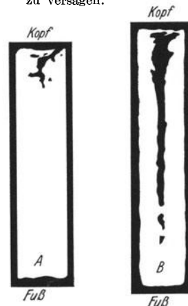
Abb. 253. Lunkerbildung. A Kopflunker, B Fadenlunker.
