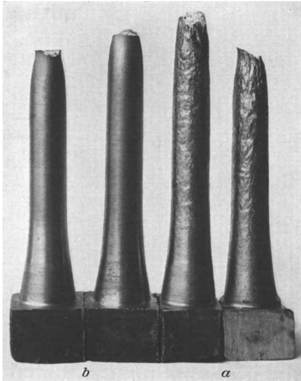
Abb. 222. Zwei nebeneinanderliegende Zugproben desselben Stahlgusses. a ungeglüht mit der typisch ausgeprägten knitterigen Oberfläche, b geglüht mit glatter Oberfläche.
