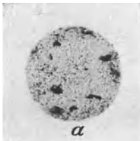
Abb. 264. (Dasselbe wie Abb. 263.) a ein von dieser Fläche genommener Schwefelabdruck, in dem sich die besonders hochangereicherten Zonen von Schwefel-Phosphor sehr dunkel abheben; b Längsschnitt am Bruch.
