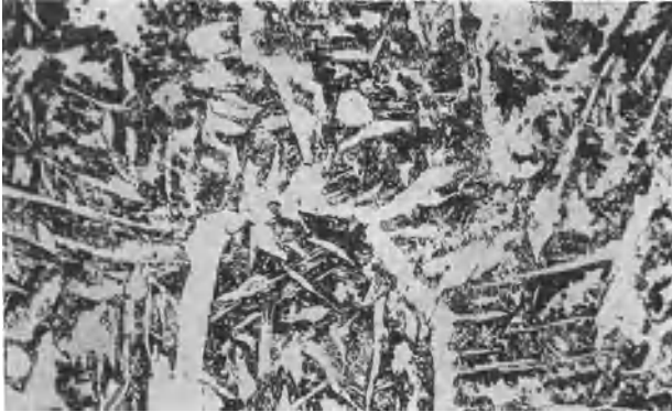
Abb. 204. Ein einer Wärmebehandlung unterzogener Werkstoff. Oberer Umwandlungspunkt wurde nicht erreicht, dagegen der A_{c1} -Punkt gerade durchschritten, daher enthält das grobe Ursprungsgefüge körnigen Perlit. 300 \times .
