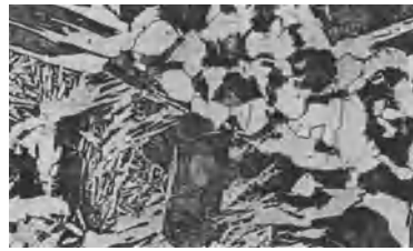
Abb. 227. Zu hoch bzw. zu lange geglüht. Teilweise Gußstruktur wie in Abb. 226.
