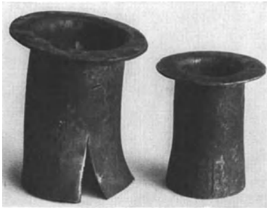
Abb. 119. Aufweit- und Bördelversuche an Flußstahlrohrenden. a Aufweitung und Bördelung bedingungsgemäß, b Aufweitprobe versagte infolge eines durch einen erheblichen Teil des Rohres durchgehenden Seigerungsfadens. Die Bördelung hat diese Fehlstelle zu verdecken vermocht (s. auch Abb. 122).
