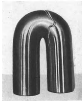
Abb. 100. Biegestab eines Spezialstabes bei 115 \text{ kg/mm}^2 \sigma_B .
