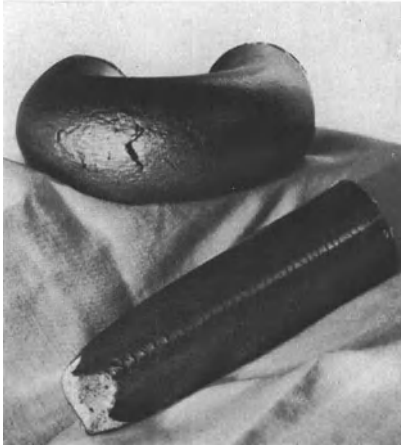
Abb. 97. Unten: Zugstab, der trotz hakenartiger Anrisse den Vorschriften genügt; oben: dazu gehöriger Biegestab, dessen Anrisse zur Verwerfung des Werkstoffes führten.
