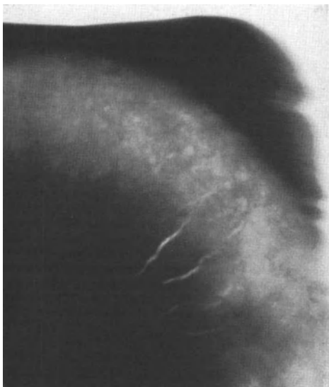
Abb. 195. Risse im gevierteilten Boden eines Gasbehälters. Die Durchstrahlungsdifferenz (dunkel und hell) ist auf den Dickenunterschied zwischen Kante und Mitte des Bodens zurückzuführen.
