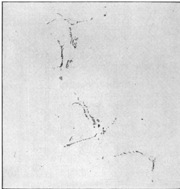
Abb. 255. Ein durch Schlacken stark verunreinigter Stahlguß. Schlacken in Kettenform aneinandergereiht. Bruchaussehen locker, schwammig (s. auch Abb. 95 b ).
