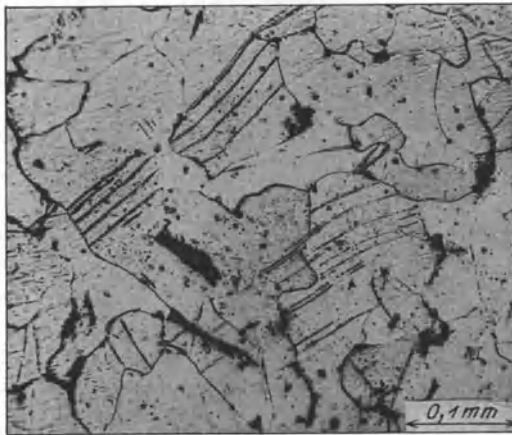
Abb. 196. Gleitlinien nach Kaltverformung in großen Kristallen (Bach und Baumann).
