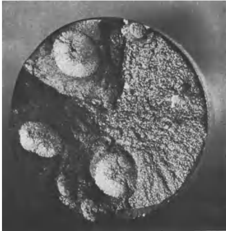
Abb. 263 zeigt 3mal vergrößert das Bruchaussehen eines stark verseigerten Probestabes aus Walzstangen.
