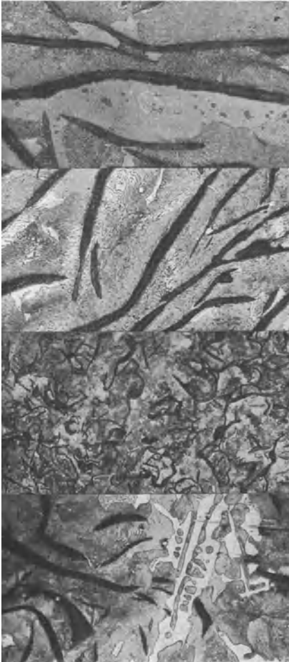
Abb. 167. Überwiegend ferritisches Gefüge mit langen Graphitadern und Verunreinigungen (Maschinenguß). (Geringe Härte, niedrige Festigkeit.) S. auch Abb. 165 a.
