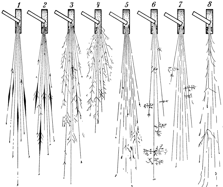
Abb. 184. Die Funkenprobe an verschiedenen legierten Stählen.
