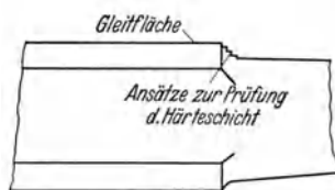
Abb. 133. Anschleifen von Absätzen einer eingesetzten Gleitbahn zur Feststellung der Kohlungs- bzw. Härtetiefe.
