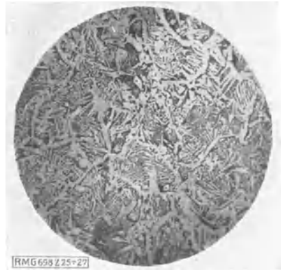
Abb. 230. Gefüge der Schweißstelle (Abschmelzschweißung) V = 67 .
