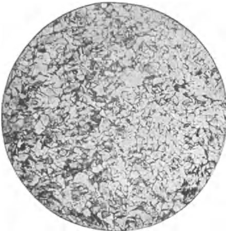
Abb. 236. Untere Schweißlage einer Lichtbogenschweißung, ausgeglüht durch Aufbringen mehrerer Schweißlagen ( V = 120 ).
