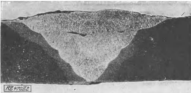
Abb. 234. Querschnitt einer Lichtbogenschweißung ( V = 1,6 ).
