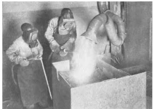
Abb. 204. Elektrische Warmschweißung eines Maschinenständers.
