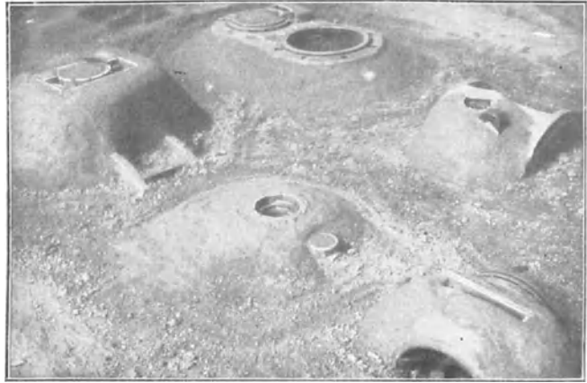
Abb. 206. Zur Warmschweißung vorbereitete Gußstücke.
