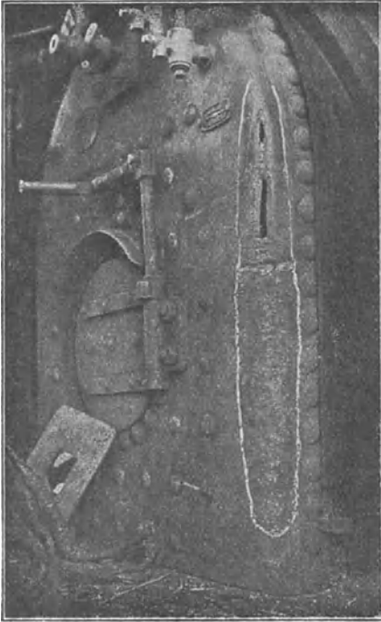
Abb. 179. Lokomotivkessel, halbfertig geschweißt.
