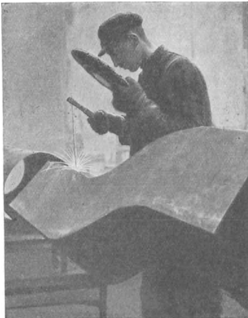
Abb. 160. Schweißung eines Ventilationschachtes.
