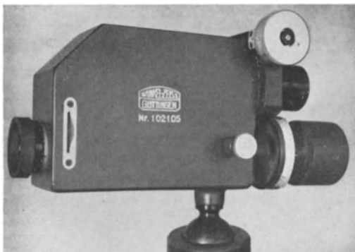
Abb. 43. Sichtphotometer von F. LÖHLE. Rechts oben die Meßtrommel, links das Okular, ganz rechts die Schutzrohre für die Objektive von Zielfernrohr und Horizontfernrohr.
