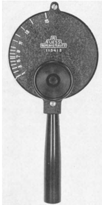
Abb. 35. Keilsichtmesser nach A. WIGAND mit einem Gelatine-Graukeil, dessen lichtzerstreuende Teilchen wie die Oberflächenstörung eines mattierten Glases wirken.
