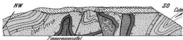
Abb. 14. Bohlenwand bei Saalfeld i. Thüringen. Profil einer ungleichförmigen Lagerung (Diskordanz und Transgression) des Zechsteins über den gefalteten Gesteinen des Devons und Kulms (Varistische Faltung).
