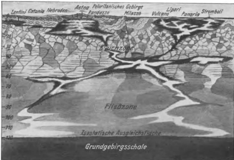
Abb. 12. Gliederung der magmatischen und plastischen Zonen der obersten Erdschicht (bis 120 km, s. Abb. 11) in ihrem Zusammenhang mit Gebirgsbau, Erdbeben und Vulkanismus. Querschnitt durch Ätna und Liparische Inseln. (Nach A. Sieberg.)
