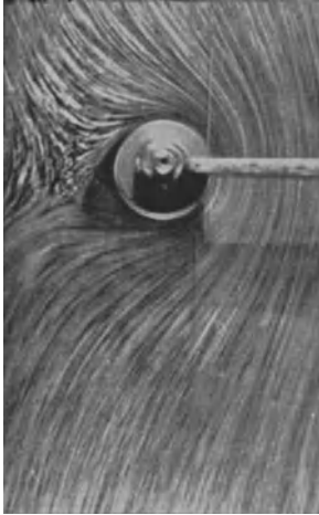
Abb. 161. Strömung um einen rotierenden Zylinder. (Nach PRANDTL.)
