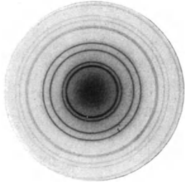
Abb. 593. Elektronenbeugung in einer Metallfolie. (Aufnahme von H. MARK.)
