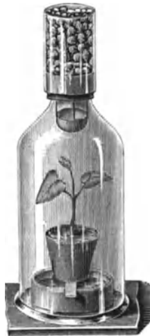
Apparat zu Culturversuchen in kohlensäurefreier Luft nach Pfeffer.
