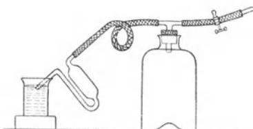
Abb. 53. Füllen des SPRENGEL-schen Pyknometers.
