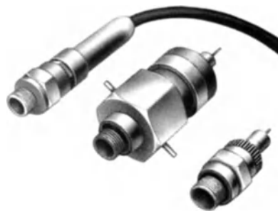
Abb. 139. Ausführung von DVL-Druckgebern für Kolbenmaschinen (36).
