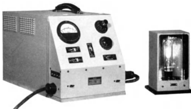
Abb. 204. AEG-Lichtblitzstroboskop mit Hochdruckquecksilberdampfampe.
