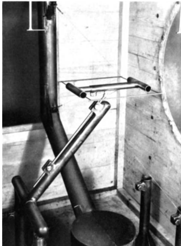
Abb. 460. Vorrichtung zum Abschirmen des vom Modell verdeckten Teiles des Tragrahmens zur Ermittlung des Luftwiderstandes der Modellaufhängung und Verspannung.
