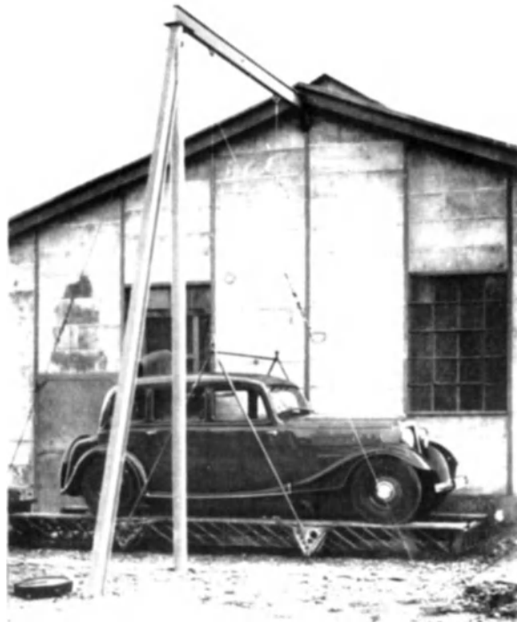
Abb. 631. Doppelfadenaufhängung von Fahrzeugen mit Trage zur Bestimmung des Trägheitsmomentes um die senkrechte Schwerpunktsachse (FKFS).
