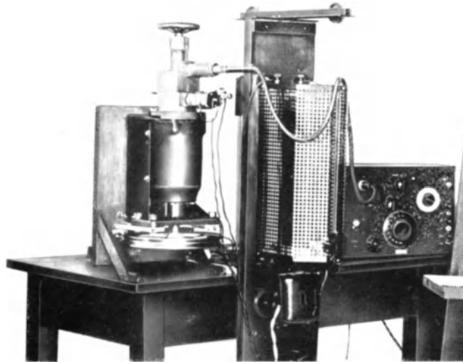
Abb. 150. Ansicht der Eichvorrichtung für Quarzgeber. [Nach N ä g e l.] Links: Elektromagnetische Druckpresse. Mitte: Schiebewiderstand. Rechts: Röhrenvoltmeter.
