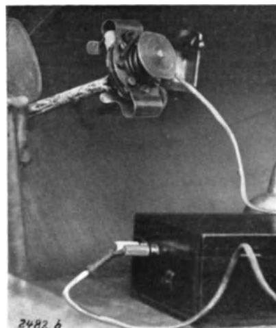
Abb. 551. Bremskraftbegrenzer im Betrieb (89).
