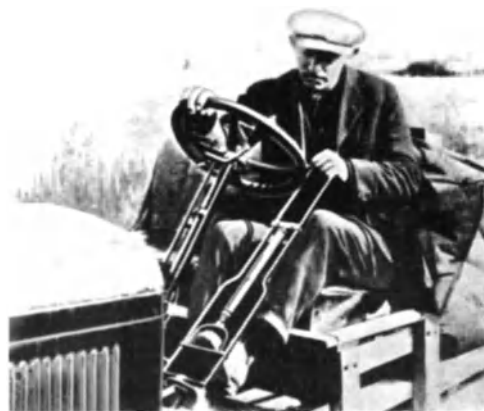
Abb. 553. Bild der Meßmethode des Kupplungspedal-druckes (250).
