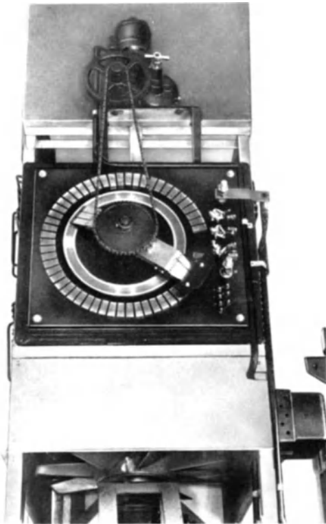
Abb. 240. Eisenbelastungswiderstand mit Stufenschalter und Belüftungsgebläse.
