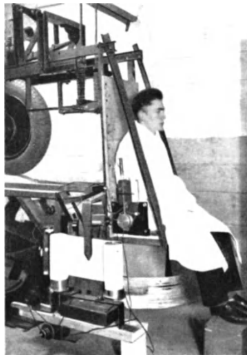
Abb. 608. Prüftisch zur Feststellung der Empfindlichkeit des Menschen gegen die Federbewegungen. [Nach Dobberack (141).]
