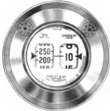
Abb. 515. Tapley-Beschleunigungsprüfer für Kraftfahrzeuge (256).
