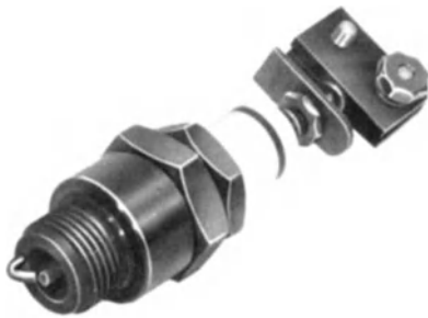
Abb. 330. Zündkerzen-Thermoelement, Mittelstift ist durchbohrt und mit Nickel-Nickelchromelement, versehen.
