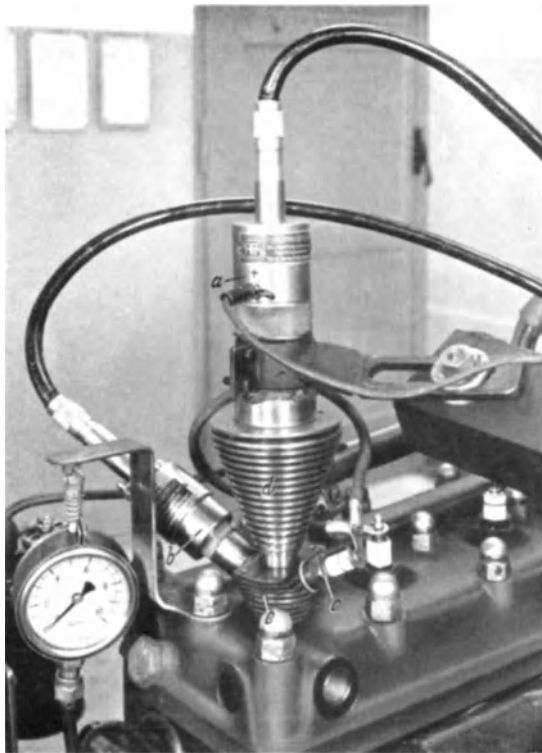
Abb. 173. Anbau der Strahlungsmeßeinrichtung des Quarzdruckgebers und der Zündkerze an einem Motor (FKFS).
