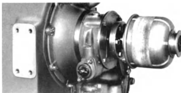
Abb. 369. Torsiograph an einem Motor angeschlossen.
