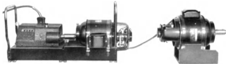
Abb. 273. FKFS-Drehzahlstichprober mit elektrischer Fernübertragung durch Gleichlaufeinrichtung.
