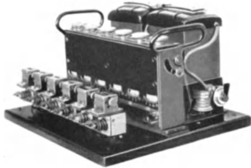
Abb. 588. 6facher Beschleunigungszähler nach Dobberack (137).
