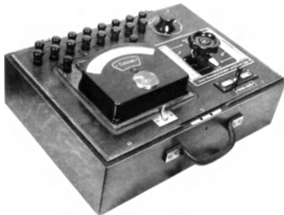
Abb. 313. Elektrisches Temperaturmeßgerät für Widerstandsthermometer mit eingebauter Meßbrücke, Stromquelle und Meßstellenumschalter (S & H).
