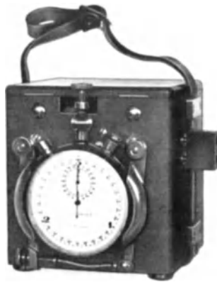
Abb. 276. Handstoppuhr in einem Magnetgehäuse mit elektromagnetisch betätigter Druckstiftauslösung (Favag Neuchatel).
