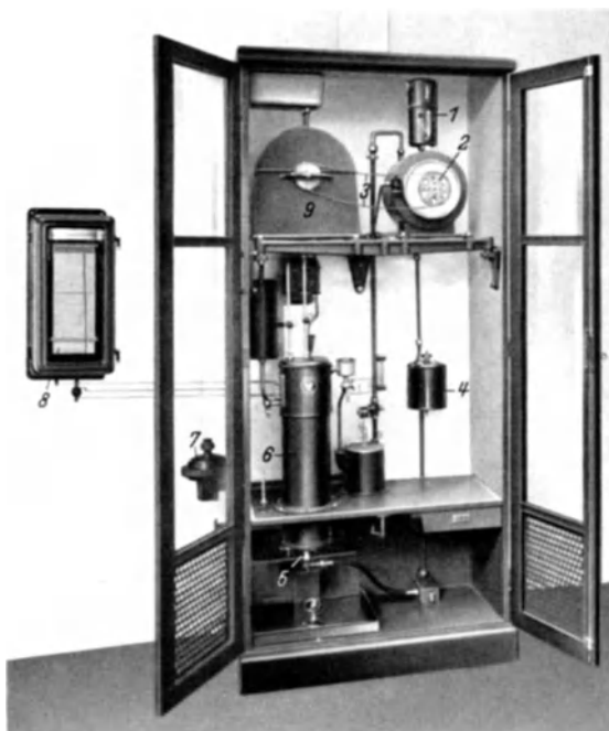
Abb. 16. Selbsttätiges Junkers-Kalorimeter mit elektrischer Anzeige und Aufschreibung (191).
