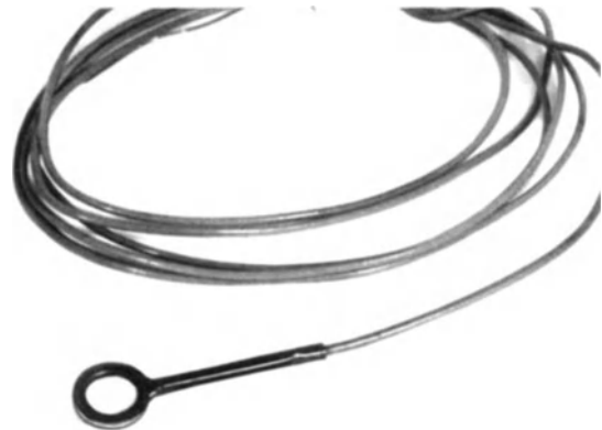
Abb. 331. Kupferkonstantan-Thermoelement, eingebaut in Kerzensitzring.
