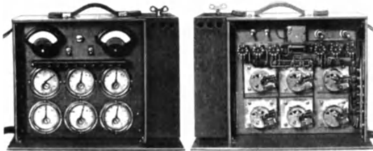
Abb. 589. 6facher Beschleunigungszähler amerikanischer Bauart.
