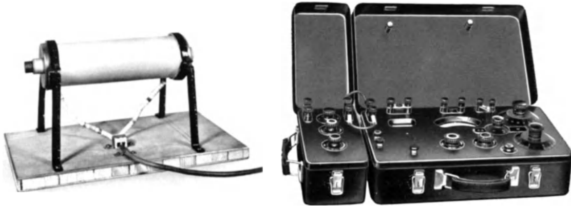
Abb. 321. Rohofen für Thermoelementeichung (FKFS).
