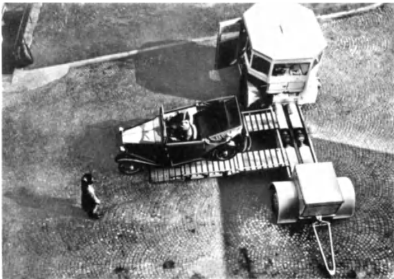
Abb. 446. Fahrerbarer Wagenprüfstand im Betrieb (Benzol-Verband).
