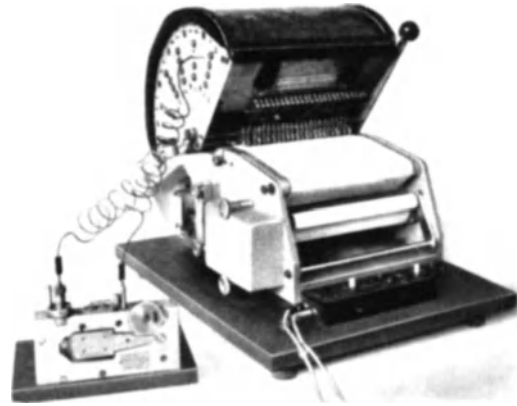
Abb. 585. Beschleunigungsmeßeinrichtung Bauart Langer-Thomé. [Nach Langer (290).]
