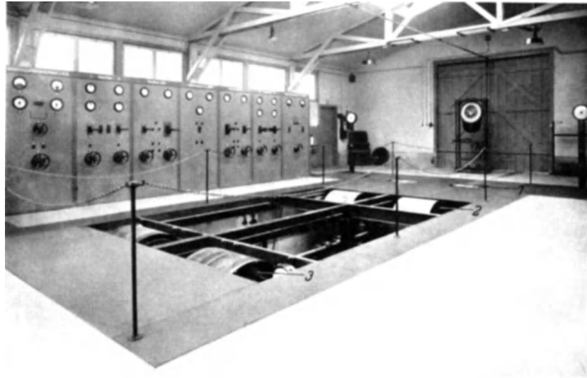
Abb. 437. Kraftwagenprüfstand. 1 Lauftrommelpaar, 2 Hilfslauftrommeln, 3 Lauftrommelgeneratoren.
