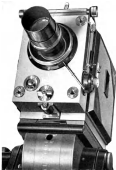
Abb. 194. Askania Hochfrequenzaufnahmegerät (Objektivseite) (Askania-Werke).
