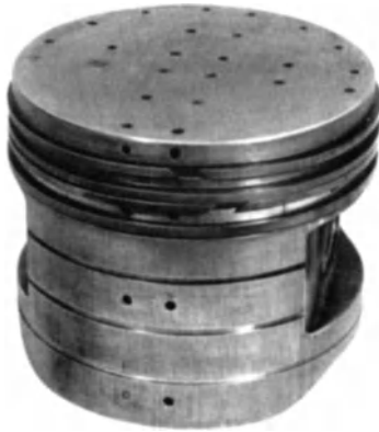
Abb. 336. Motorenkolben mit Anbohrungen zum Einpfropfen von Schmelzkegeln.
