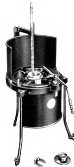
Abb. 10. Flamm- und Brennpunktprüfer mit offenem Tiegel nach Marcusson (209).
