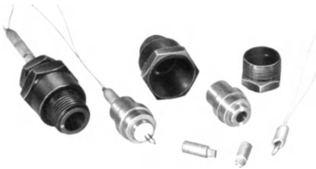
Abb. 329. Einschraubthermoelement zur Messung der mittleren Temperatur im Verbrennungsraum.
