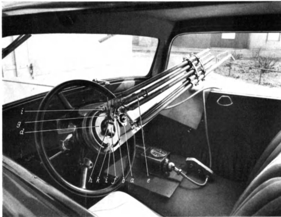
Abb. 642. Ansicht der selbsttätigen FKFS-Lenkvorrichtung eingebaut in einen Adler-Trumpf-Wagen. a Steuernocken; b zwei übereinander liegende Klinkenhebel; d Seilscheiben; e Zugfedern; f Mitnehmerbolzen; g Zapfen; h Hebel; i Anschläge; k Mitnehmer.
