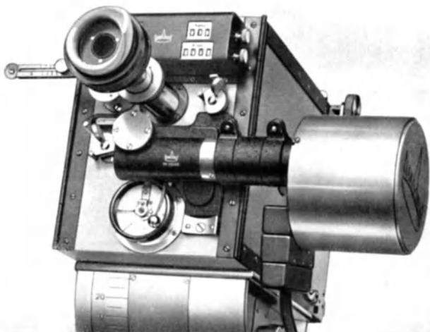
Abb. 205. Angesetztes Einerganggetriebe mit Magnettrieb, der vom Zeitraffergerät in bestimmten Zeitabständen die Einbildaufnahmen schaltet (Askania-Werke).
