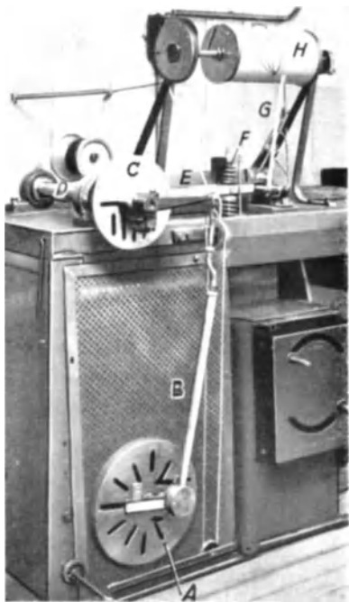
Abb. 559. Stoßdämpferprüfstand (135). A Planscheibe; B Schubstange; C Planscheibe; D Welle; E Hebel; F geeichtes Federpaar; G Winkelhebel; H Schreibtrommel.
