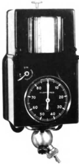
Abb. 531. „Tel“-Anfahr- und Bremsgeschwindigkeitsmesser (Hasler A.G., Bern).
