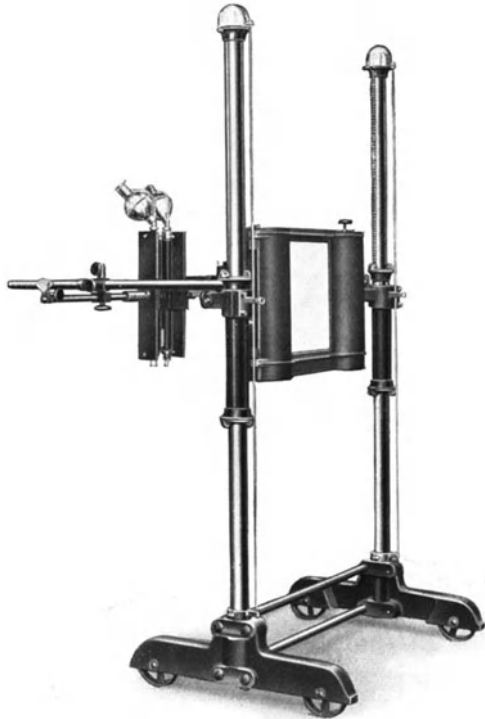
Abb. 138. Siemens Stereo- und Serienaufnahmegert mit zwei Röhren. Die Aufnahmen werden auf Rollfilm gemacht, der zwischen zwei Verstärkungsschirmen gepreßt wird.
