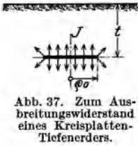
Abb. 37. Zum Ausbreitungswiderstand eines Kreisplatten-Tiefenerders.
