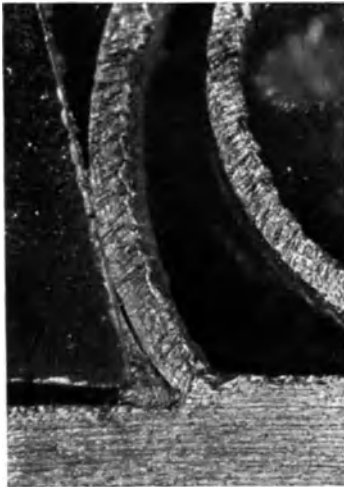
Abb. 18. Spanentstehung bei kleiner Schnittgeschwindigkeit (Bildung einer Aufbauschneide am Schneidstahl) nach SCHWERD.
