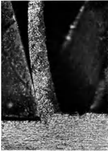
Abb. 19. Spanentstehung bei hoher Schnittgeschwindigkeit (glatte Schneide) nach SCHWERD.
