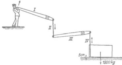
Abb. 52. Komplizierterer Hebelmechanismus.
