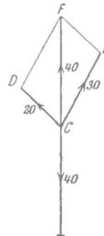
Abb. 32. Parallelogramm der Kräfte.
