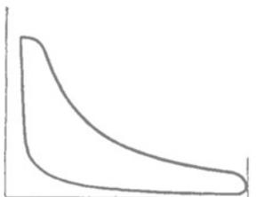
Abb. 107. Praktisch erzieltbares Dampfdiagramm.
