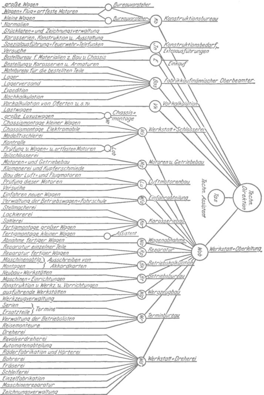
Abb. 152. Schema für die Organisation der technischen Abteilung eines großen Fabrikbetriebes.
