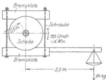
Abb. 100. Bremse zur Feststellung der abgegebenen Maschinenleistung.
