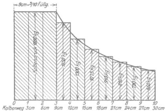
Abb. 60. Schaulinie der Kolbenkräfte (Dampfdiagramm) bei einer Dampfmaschine.
