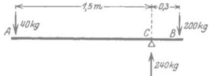
Abb. 3. Darstellung eines Hebels, noch weiter schematisiert.
