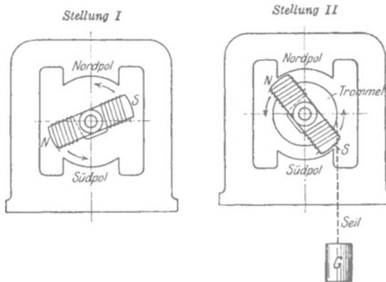
Abb. 83. Schematische Darstellung der Wirkungsweise eines Elektromotors.
