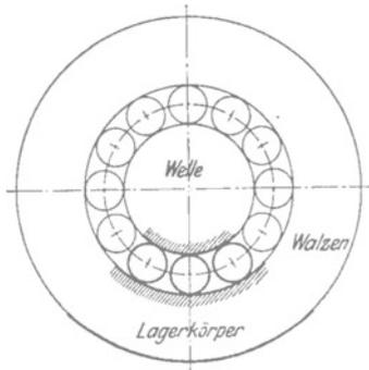
Abb. 75. Rollenlager.
