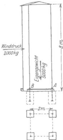
Abb. 18. Gleichgewicht bei einem vom Winddruck erfaßten Turm.
