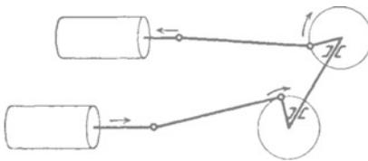
Abb. 63. Dampfmaschine mit zwei Zylindern; Kurbeln um  $90^\circ$  versetzt.
