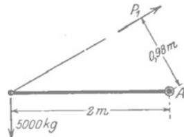
Abb. 41. Tragkonstruktion nach Abb. 38, als Hebel berechnet.
