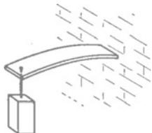
Abb. 129. Biegung eines flach gelegten Brettes.
