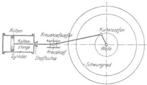
Abb. 72. Die Reibung verursachenden Teile einer Dampfmaschine.
