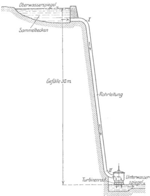
Abb. 81. Wasserkraftanlage.
