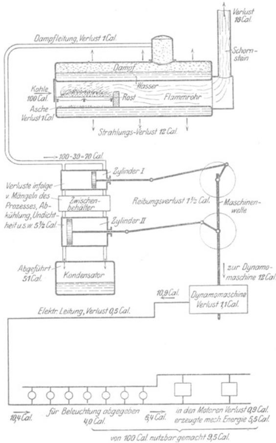
Abb. 102. Ausnutzung der Wärme in einer Dampfanlage zur Erzeugung von Elektrizität.
