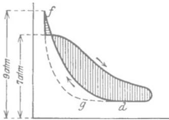
Abb. 110. Diagramm mit zu starker Kompression.
