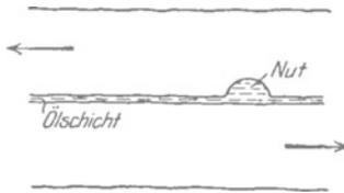
Abb. 71. Wirkung der Schmierung.
