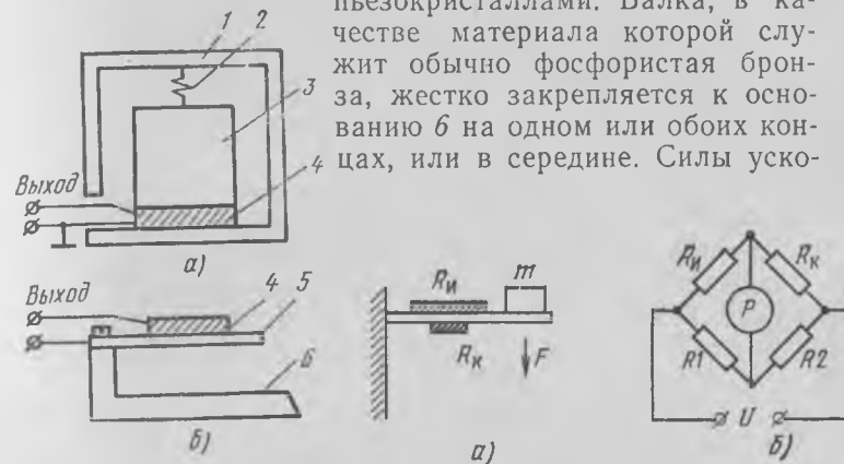
РИС. 8.7. Конструктивные схемы пьезоэлектрических акселерометров
