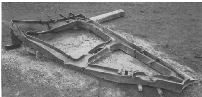
Abb. 84. Verbogener gußeiserner Unterstütsbock.
