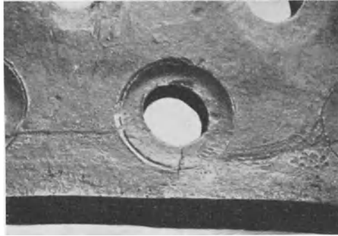
Abb. 109. 2 mm tiefe Einprägung des Nietkopfes.
