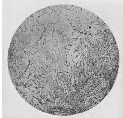
Abb. 134. Schweiße eines 6 mm dicken Bleches mit leichtumhülltem Schweißstab und Gleichstrom (96). Rechts Übergang zur Schweißnaht. Vergr. 150fach.
