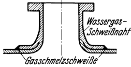
Abb. 95. Verstärkter Stutzen.
