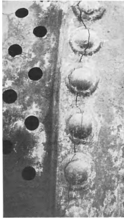
Abb. 46. Rißbildungen an der Nietung eines Teilkammerkessels.
