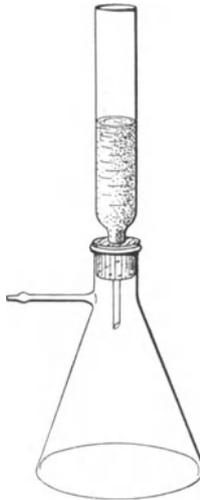
Abb. 5. Einfache Adsorptionsvorrichtung.
