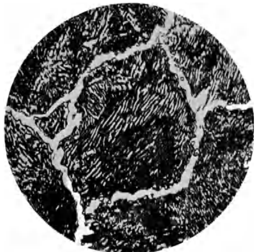
Fig. 59. Kleingefüge eines Siemens-Martin-Stahles mit einem C-Gehalt von 1,50 v. H.
