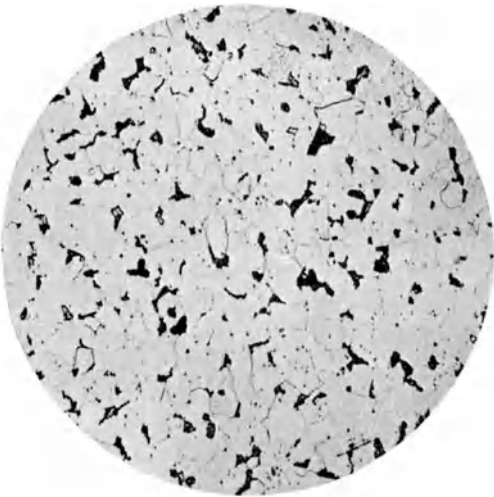
Fig. 54. Kleingefüge eines Siemens-Martin-Stahles mit einem C-Gehalt von 0,13 v. H.
