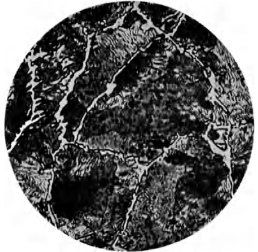
Fig. 57. Kleingefüge eines Siemens-Martin-Stahles mit einem C-Gehalt von 1,29 v. H.
