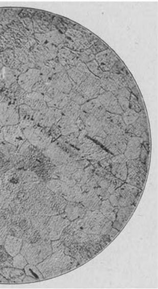
ast kohlenstofffreies Flußeisen eneinschlüssen. Vergrößerung (Zu Seite 94.)
