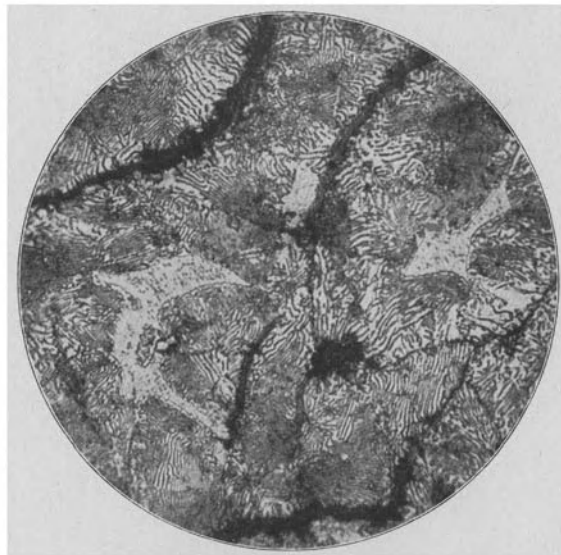
Fig. 18. Graphit, Perlit und Ledeburit oder Phosphid. Graues Roheisen. Vergrößerung 500 fach. (Zu Seite 97.)
