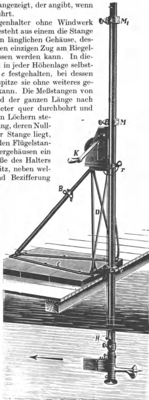
Abb. 83. Flügel an hängender Stange mit Stangenhalter und Windtrommel.
