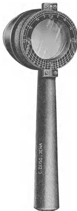
Abb. 118. HERSCHEL'Sches Doppelprisma mit LANDOLTScher Teilung nach C. ZEISS <13/14 132>.
