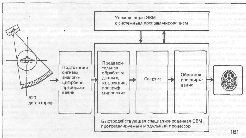
Рис. 181. Принципиальная схема работы компьютерного томографа.
