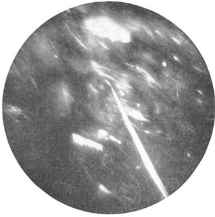
Abb. 48. Stäbchensole (Vanadinpentoxydsol im Dunkelfeld. Kardioidkondensor, Obj. Zeiss spez. X, komp. Ok. 15 mal). Ein stäbchenförmiges Ultrateilchen wird mit einer Mikronadel berührt.
