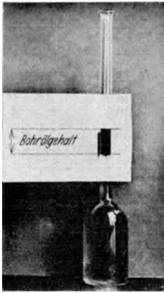
Abb. 24. Meßzylinder zur Prüfung der Bohrölkonzentration.
