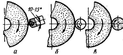
**Алмазно-металлические карандаши.** Карандаши представляют собой латунные или стальные цилиндрики длиной 45—55 мм, диаметром 6—8 мм, в которых алмазные зерна сцементированы цинкоалюминиевым сплавом. Хвостовая часть оправки предназначена для крепления карандаша на станке.
