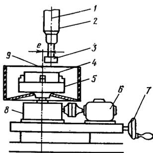
**74.** Сверлильный станок модели 2Н118, оснащенный специальным устройством:
