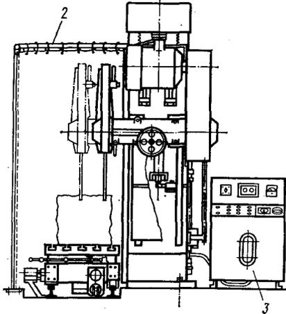
Для подачи СОЖ в зону резания, сбора и очистки охлаждающей жидкости на станке имеется насосно-фильтрующая установка, которая состоит из бака вместимостью 500 л и насосной установки ВКС-1/16i
