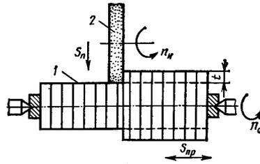
77. Схема продольного шлифования:
