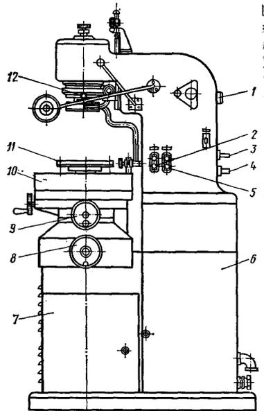
**73.** Станок УЗСК-80 для ультразвуковой обработки цветных камней:
