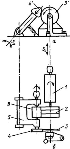
68. Схема обработки сложных по контуру вставок на станке Г-102: а — копирное устройство; б — станок
