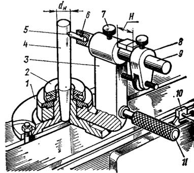
тель перемещают до соприкосновения торца кольца 8 с плоскостью стойки 3 *та.* закрепляют винтом 7.
