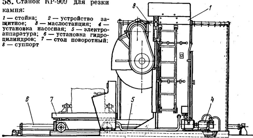
На стойке смонтирован привод для вертикального перемещения суппорта. Суппорт состоит из каретки, на которой смонтированы шпиндельная бабка и привод шпинделя. Каретка перемещается по направляющим стойки 1. Отрезной круг на шпинделе крепится при помощи прижимных дисков. Верхняя часть круга закрыта защитным кожухом. На станке предусмотрена возможность установки до четырех отрезных кругов. Для этого производится замена прижимных дисков и крышки защитного кожуха.
