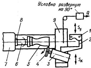
66. Схема модернизированного токарного станка для скоростного шлифования:
