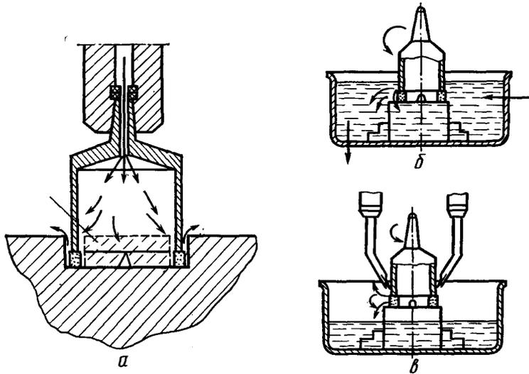
**61.** Схемы подачи СОЖ в зону обработки:
