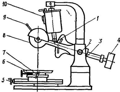
**59. Станок СРК для резки камня:**
