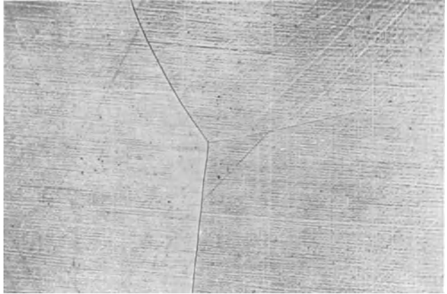
Abb. 110. 49,64% Cu. Bei 603° abgeschreckt. v = 100 .
