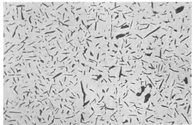
Abb. 149. 30,05% Cu. Behandlung wie bei Abb. 148 und darauf 20 Std. bei 390° geglüht und abgeschreckt. v = 200 .
