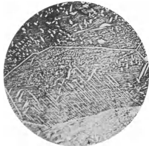
Abb. 32. v = 150 . 54,20% Cu. Feingefüge eines anderen Stückes nach zehntägigem Glühen bei 445^\circ . \alpha -Kristalle (weiß) kristallisieren aus den Körnern des scheinbaren \beta (Carpenter).
