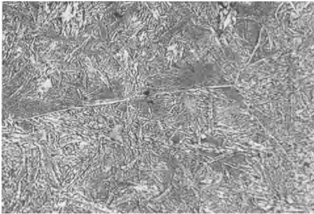
Abb. 86. 61,30% Cu. Bei 844° in Eiswasser abgeschreckt. v = 100 .
