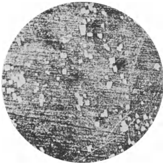
Abb. 42. v = 150 . Ausscheidung zahlreicher weißer Kristalle, hauptsächlich von kubischer oder oktaedrischer Gestalt, aus der \beta -Kristallart durch wiederholtes Abschrecken in flüssiger Luft (Carpenter).
