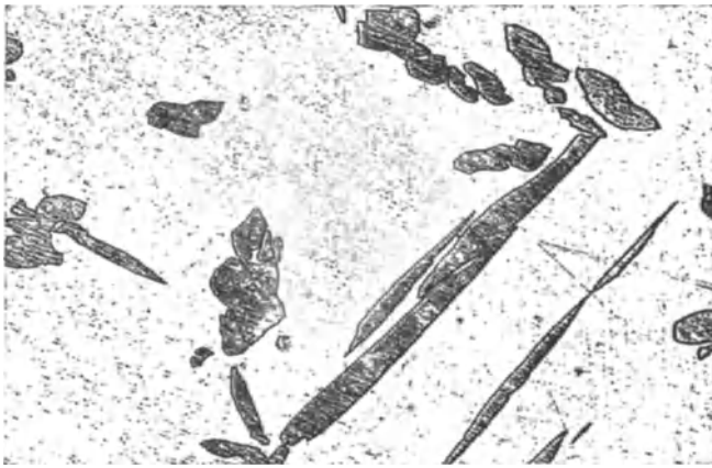
Abb. 100. 56,45% Cu. Bei 500° abgeschreckt (s. Tabelle 46). v = 100 .
