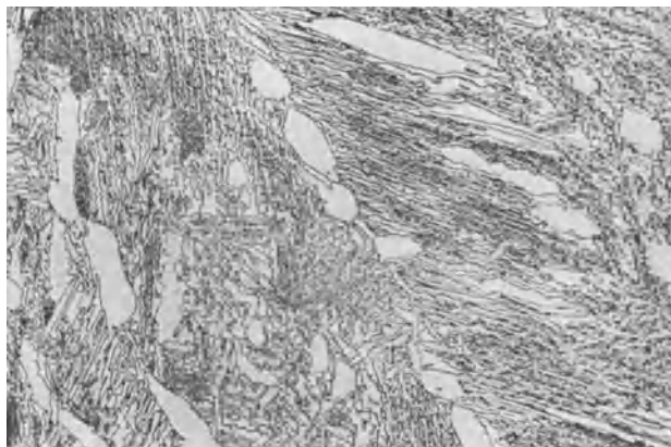
Abb. 89. 61,35% Cu. Bei 819^\circ in Eiswasser abgeschreckt. v = 100 .
