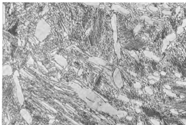
Abb. 90. 61,26% Cu. Bei 811^\circ in Eiswasser abgeschreckt. v = 100 .
