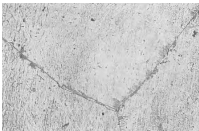
Abb. 96. 59,34% Cu. Bei 742^{\circ} in Eiswasser abgeschreckt. v = 100 .
