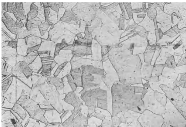
Abb. 81. 60,98% Cu. Behandlung wie Abb. 80 und darauf weitere 3 Tage bei 400° geglüht und abgeschreckt. v = 100 .
