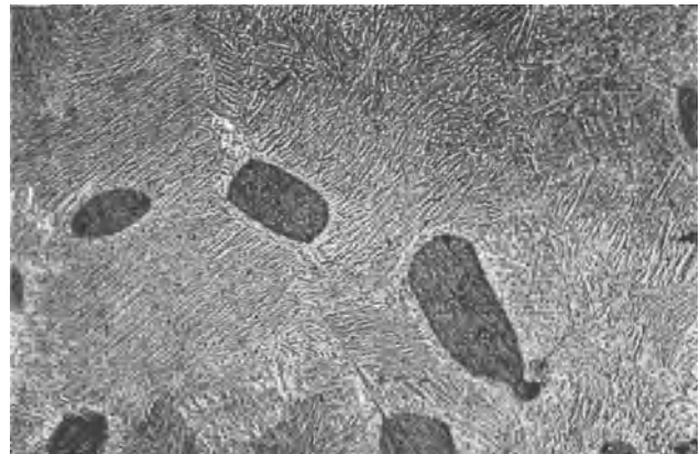
Abb. 163. 24,04% Cu. 2\frac{1}{2} Std. bei 580° geglüht und in Kältemischung von -13° abgeschreckt. v = 100 .
