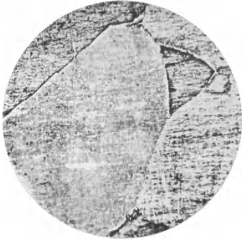
Abb. 29. v = 150 . 54,20% Cu, gegossen. Große Körner von scheinbarem \beta mit dünnen, hellen \alpha -Säumen, hauptsächlich im oberen Teil des Bildes (Carpenter).
