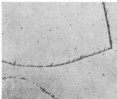
Abb. 45. \text{NH}_3 -Ätzung. v = 100 . 55,4% Cu. Gegossen (Hudson).
