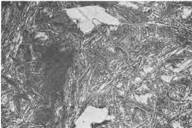
Abb. 87. 61,35% Cu. Bei 828° in Eiswasser abgeschreckt. v = 100 .
