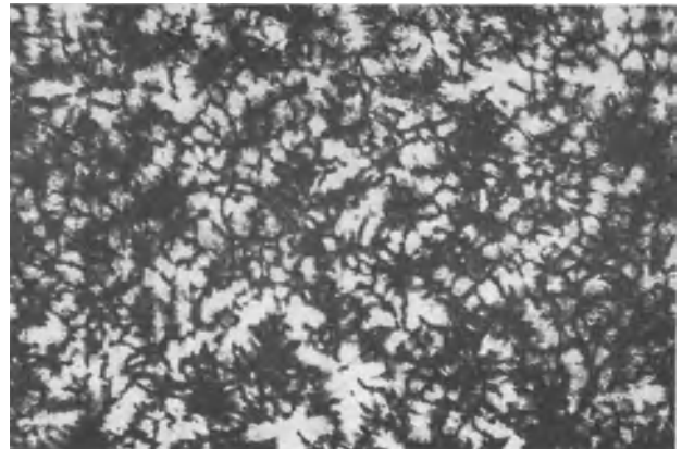
Abb. 169. 14,15% Cu. Gegossen. v = 200 .
