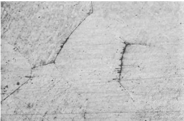
Abb. 168. 20,88% Cu. 2 Std. bei 580° geglüht und in Kältemischung von -14° abgeschreckt (nur \epsilon ). v = 100 .
