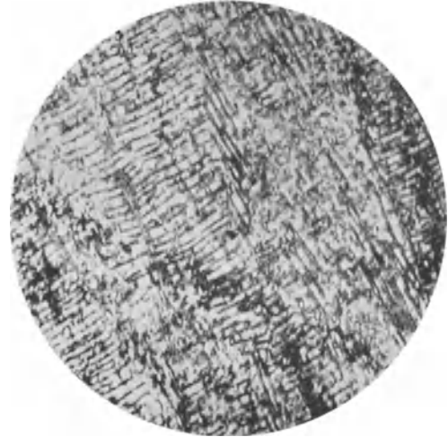
Abb. 30. v = 400 . 54,20% Cu, drei Tage bei 420-430^\circ geglüht. Zerfall von \beta in lamellares Eutektoid ( \alpha + \gamma ). Die Struktur ist typisch perlitisch (Carpenter).
