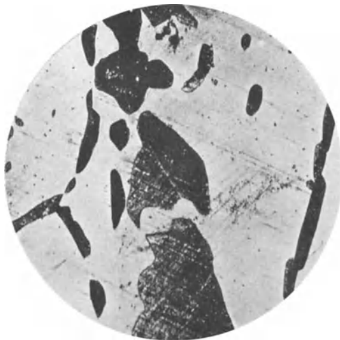
Abb. 40. v = 150 . 50,35% Cu, nach siebenwöchiger Glühung bei 445° (Carpenter).
