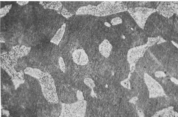
Abb. 164. 21,95% Cu. 2 Std. bei 475–480° geglüht und bei 475° in Eiswasser abgeschreckt. v = 100 .
