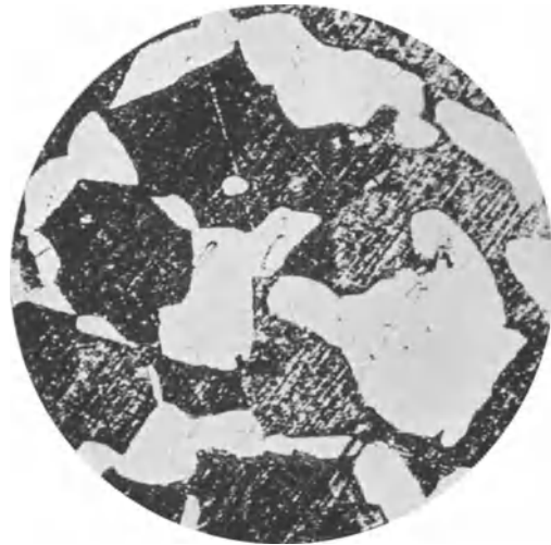
Abb. 35. v = 150 . 54,20% Cu. Nach achtwöchigem Glühen bei 445^\circ . Zeigt die annähernde Beendigung des Zerfalls. \alpha = weiß, \gamma = dunkel (Carpenter).
