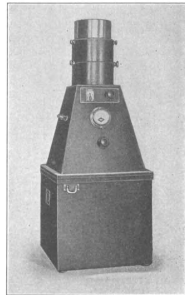
Bild 37. Erstes Modell des Elektronenstrahl-Flugzeugkompaß.
