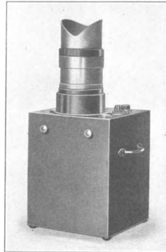
Bild 30. Elektronenstrahl-Meßgerät zur Festlegung der Richtung und Größe eines magnetischen Feldes in der Horizontalen.
