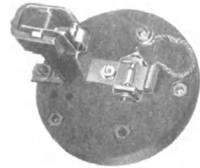
Bild 2. Kontakt- und Magnetanordnung am Temperaturregler.
