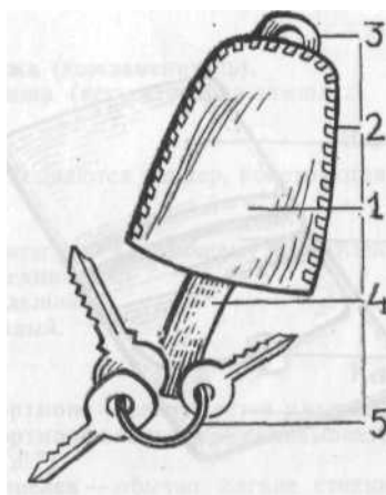
Рис. 220. Кошелек для ключей: 1 — стенка; 2 — кант; 3 — кнопка; 4 — выдвигающаяся полоса; 5 — кольцо
