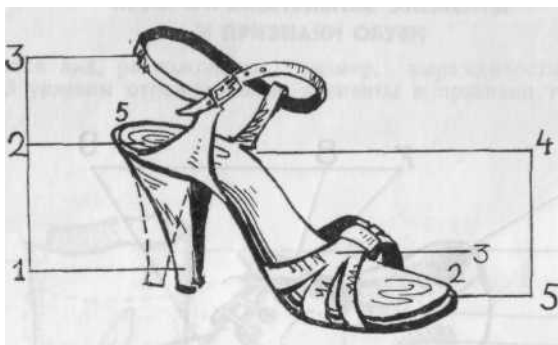
Рис. 203. Босоножка: 1 — искривление каблука; 2 — потертость стельки; 3 — трещины ремешков; 4 — оторванность ремешка; 5 — оторванность стельки
