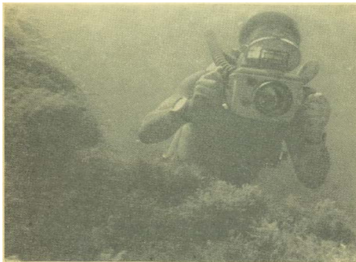
Рис. 63. Подводник с боксом „УКП”. Условия съемки: камера „Ленинград”; объектив „Гидроруссар”; диафрагма 8; пленка А-2; 1/100 сек.; 10 час.; глубина 14 м.
