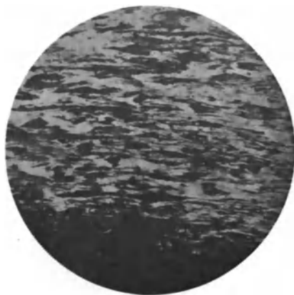
Fig. 138*. Eisenbahnradreifen. Verzerrung der Kristalle an der Lauffläche des Reifens. V = 94 .
