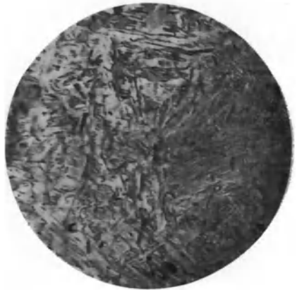
Fig. 83. Kern von Fig. 81. Gefüge: Martensit. V = 450 .
