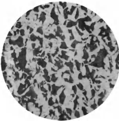
Fig. 56. Eisen mit 0,4% Kohlenstoff. Gefüge: Ferrit und Perlit. V=75 .
