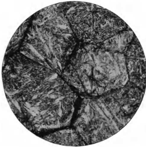
Fig. 75*. Werkzeugstahl mit 1,54% Kohlenstoff, bei 1280° C in Wasser abgeschreckt. Härterisse. V = 200 .
