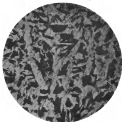
Fig. 137*. Eisenbahnradreifen, normales Gefüge. V = 94 .
