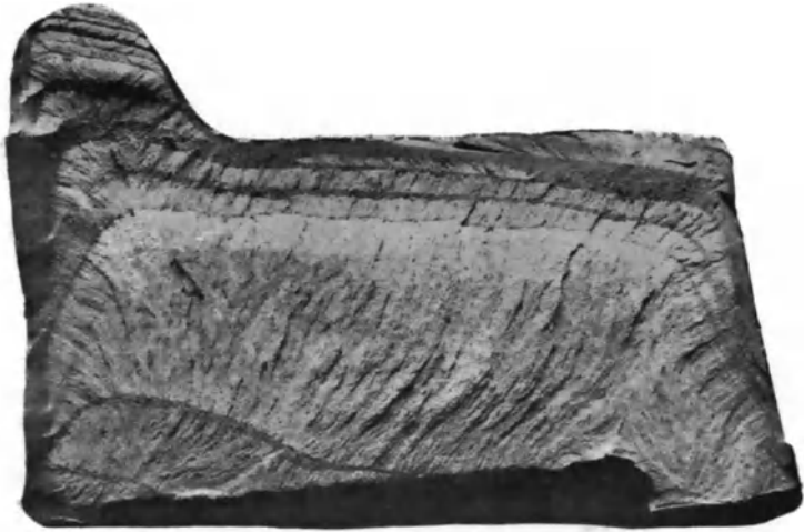
Fig. 17a*. Radreifen, Bruchfläche.
