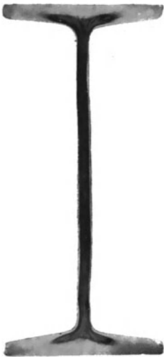
Fig. 13. I-Flußeisen mit starker Seigerung.
