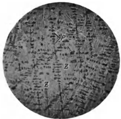
Fig. 97. Hartguß, Rand. Gefüge: Perlit und Zementit. V = 52 .
