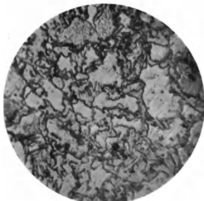
Fig. 68. Kohlenstoffarmes Eisen, bei 750^{\circ} C abgeschreckt. Gefüge: Ferrit und Martensit. V = 350 .
