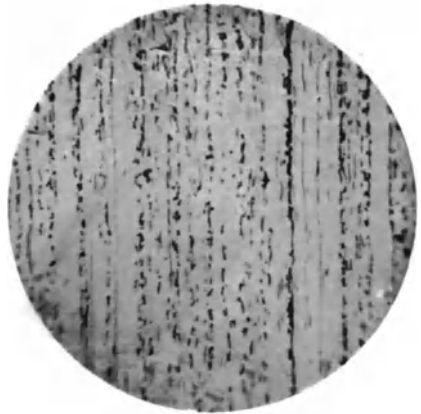
Fig. 124. Kaltgewalztes Flußeisen; Walzstruktur. V = 72 .
