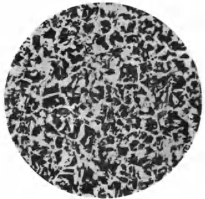
Fig. 111*. Stahlguß (wie Fig. 110), gegläht. Kornstruktur. V = 46 .
