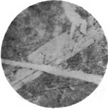
Fig. 62. Stahlnadelriß in dem Material der Fig. 59. V = 450 .
