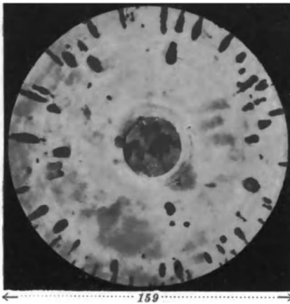
Fig. 9* 2) ). Querschnitt durch einen Gußblock mit Gasblasen.
