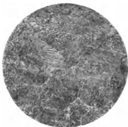
Fig. 76b. Dasselbe Material wie bei Fig. 76a, nach dem Ausglühen. Gefüge: lamellarer Perlit. V = 450 .
