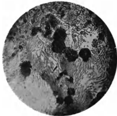
Fig. 103. Temperguß, Kernzone, wie Fig. 102, aber in stärkerer Vergrößerung. V = 102 .
