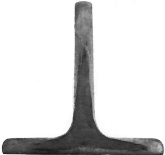
Fig. 14. T-Flußeisen mit starker Seigerung.
