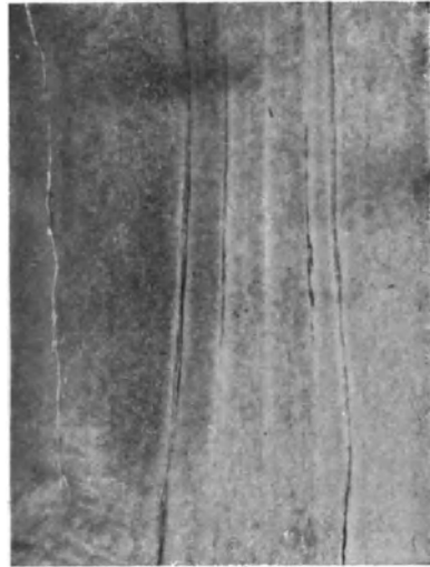
Fig. 10*. Längsschnitt durch einen gewalzten Block; langgewalzte Gasblasen.
