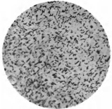
Fig. 55. Eisen mit 0,13% Kohlenstoff. Gefüge: Ferrit und Perlit. V = 75.
