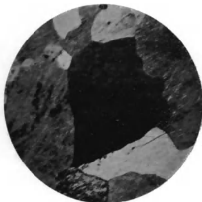
Fig. 117. Das gleiche Flußeisen wie Fig. 116, nach 36stündigem Glühen. V = 67.
