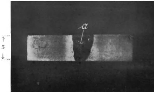
Fig. 40. Metallischer Einschuß in einen Chromnickelstahl.
