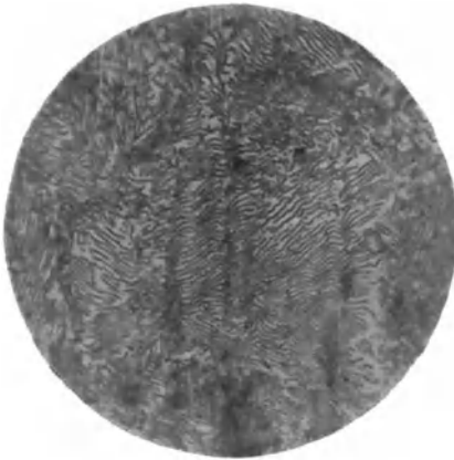
Fig. 58. Eisen mit (nahezu) 0,9% Kohlenstoff. Gefüge: Perlit. V=450 .
