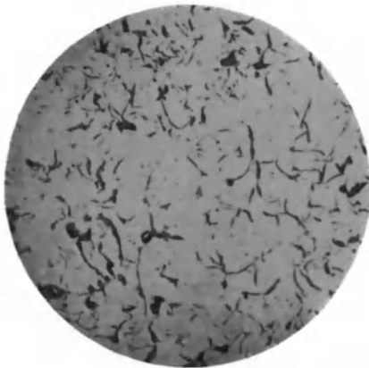
Fig. 91. Graues Gußeisen, ungeätzt. Graphitadern. V = 75 .
