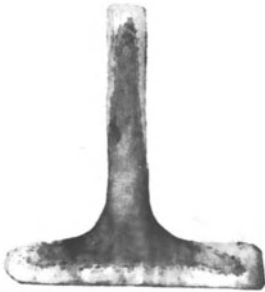
Fig. 15a. T-Flußeisen mit starker Phosphorseigerung.
