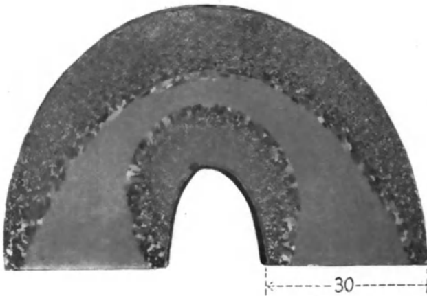
Fig. 139*. Bei 750^{\circ} C gebogener Stab aus kohlenstofffreiem Weicheisen, 6 Stunden bei 730^{\circ} C geglüht.
