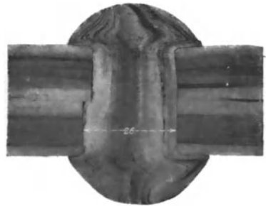
Fig. 26. Nietung, Flußeisenblech und Schweißeisenniet.
