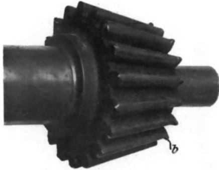
Fig. 84. Kegelnrad mit starker Abnutzung der Zähne.
