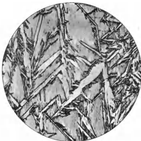
Fig. 66*. Werkzeugstahl, mit 1,57% Kohlenstoff; bei 1350° C in Wasser von 5° C abgeschreckt. Gefüge: grobe Martensitnadeln in Austenit. V = 350.
