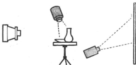
Рис. 105. Схема освещения стеклянного изделия двумя осветителями
