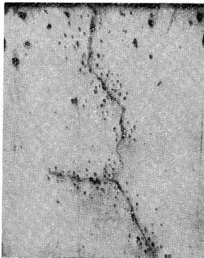
Рис. 94. Локализация пор вблизи границ зерен латуни при сублимации в вакууме в условиях воздействия растягивающих напряжений ( $\sigma \approx 15$  кгс/мм<sup>2</sup>)
