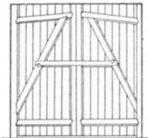
sämtliche Holzteile mit Karbolineum gestrichen, anzufertigen und anzubringen, einschließlich der erforderlichen Beschläge, bestehend aus 2 Paar Langbändern 10/50 mm stark, 1400 mm lang, mit durchgehenden,  $\frac{3}{4}$ " starken Nocken, 1 Sturmstange  $\phi$  26 mm, 2500 mm lang, sowie Verschußholm mit Schließbauge auf eiserner Platte genietet, Verschußblech und Vorhängeschloß mit zwei Schlüsseln:
