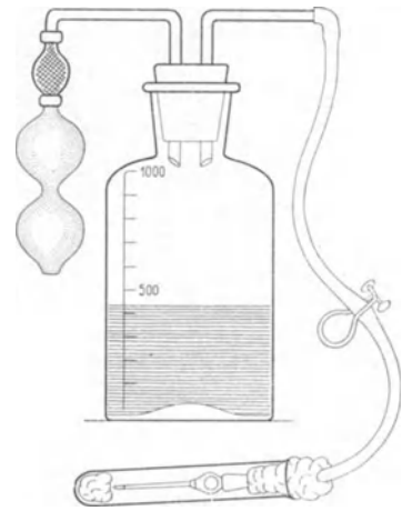
Abb. 32. Entnahmeapparatur nach BALACHOVSKIJ und GINZBURG. Herstellung von Vakuum in der Flasche mittels einer Saugpumpe (Zeichnung Schmid).
