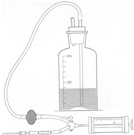
Abb. 66. Infusion des Blutes mit einer Zweiwegspritze nach Filtrierung (ELLIOTT). (Zeichnung Schmid.)
