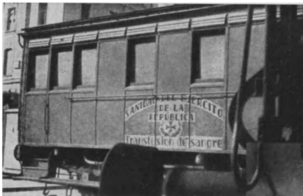
Abb. 68. Eisenbahnwagen mit Kühlvorrichtung für den Bluttransport an die ortsanische Front nach DURAN JORDA. (Revista de sanidad di guerra.)
