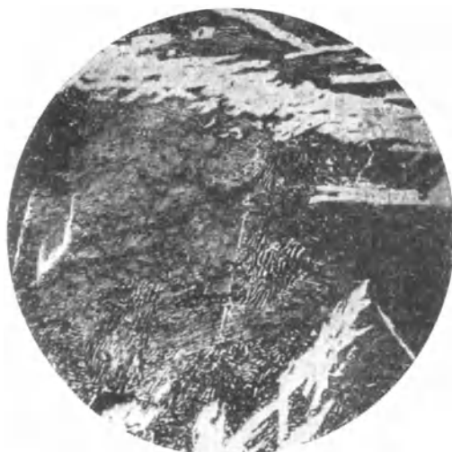
Abb. 5. Zementit (hell) + Perlit (lamellar).
