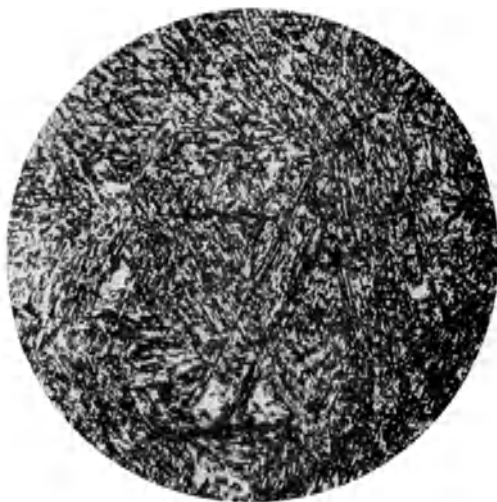
Abb. 6. Martensit. Eisenkohlenstofflegierung mit 0,5% C bei 950^{\circ} in Wasser abgeschreckt.
