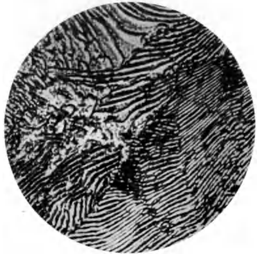
Abb. 3. Perlit. Eutektoid mit 0,9% C. Mechanisches Gemenge aus Zementit- und Ferritlamellen.
