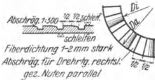
Abb. 243. Einbund-Druckring.
