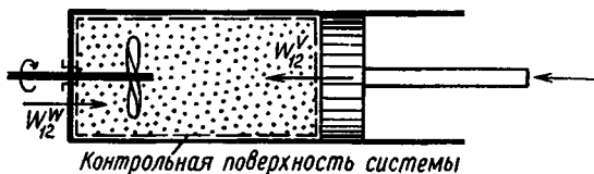
Рис. 2.10. Сочетание работы изменения объема W_{12}^V и работы на валу W_{12}^W .
