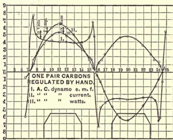
Fig. 174. Electric Arc.
